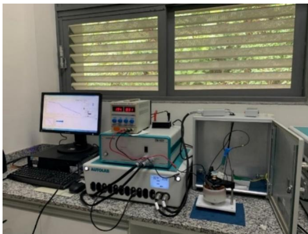
Figura A.21: Potenciostato e célula eletroquímica com controle de temperatura.
