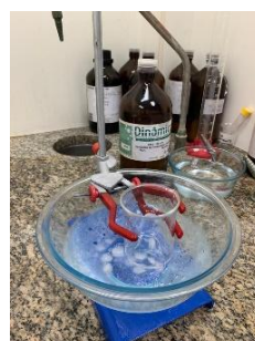
Figura A.4: a) H 2 SO 4 . b) H 2 O 2 . c) Banho de gelo. d) Chapa aquecedora.
