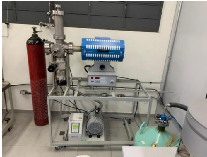
Figura A.15: Forno tubular para tratamento térmico.
