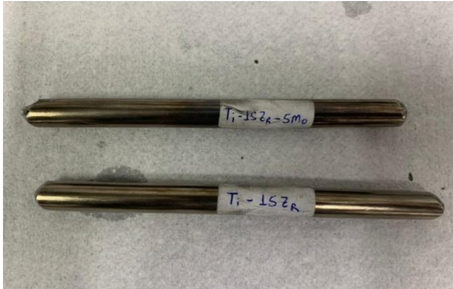
Figura A.17: Amostras de Ti-15Zr e Ti-15Zr-5Mo depois do forjamento.
