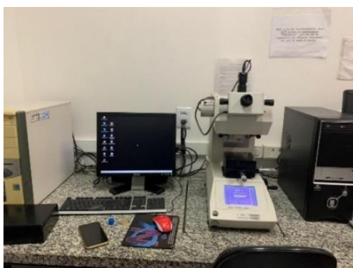
Figura A.7: a) Microdurômetro. b) Foto da indentação.
