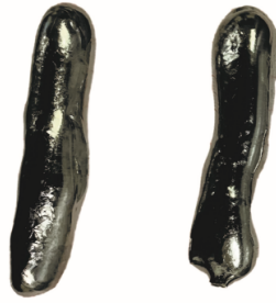
Figura A.14: Fusão Bruta Ti-15Zr e Ti-15Zr-5Mo.
