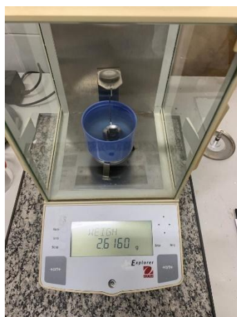
Figura A.19: Balança analítica com kit de densidade.
