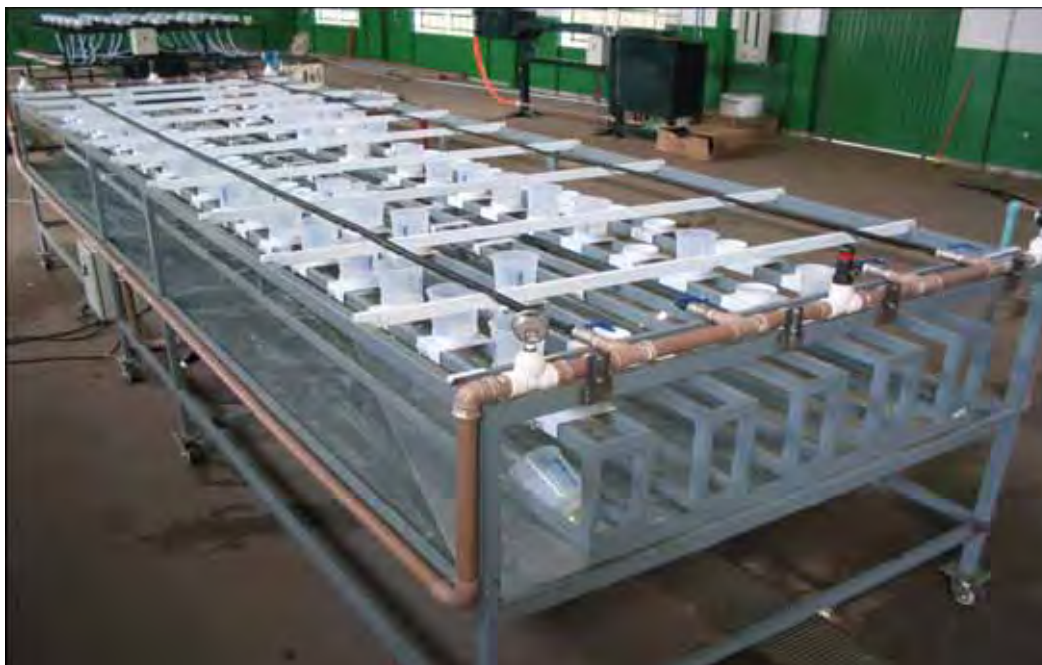
Figura 1: Vista geral da bancada de ensaios para tubos gotejadores
