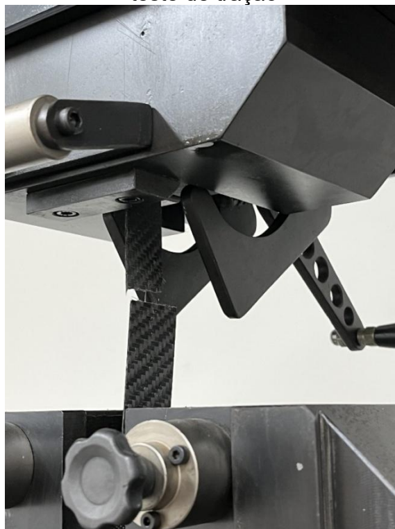
Figura 20 – Corpo de prova posicionado na máquina universal de ensaios durante o teste de tração
