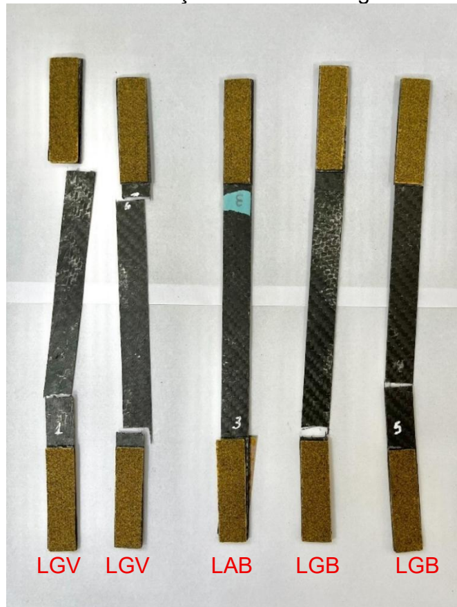
Figura 22 – Modos de falha dos laminados com 2 camadas de fibra de carbono após o ensaio de tração no sentido longitudinal
