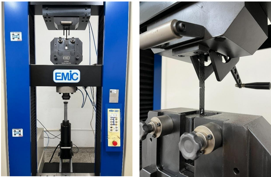
Figura 16 – Máquina EMIC DL 30000 utilizada no ensaio de tração
