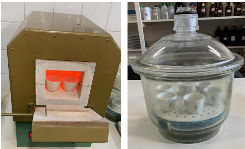
Figura 17– Amostras posicionadas na mufla durante o ensaio de calcinação e no dessecador
