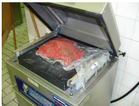
FIGURA 4: Cortes cárneos embalados a vácuo em filme “cook in”, pronto para cozimento
