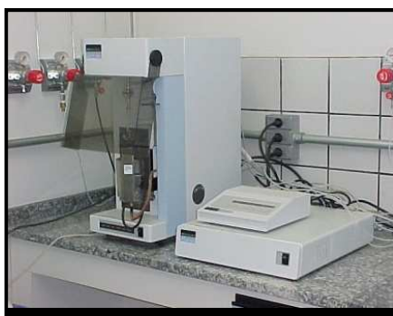
Figura 16: Analisador termogravimétrico Perkin Elmer modelo TGA 07.
