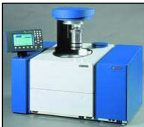
Figura 12: Bomba calorimétrica isotérmica modelo IKA C-5000.
