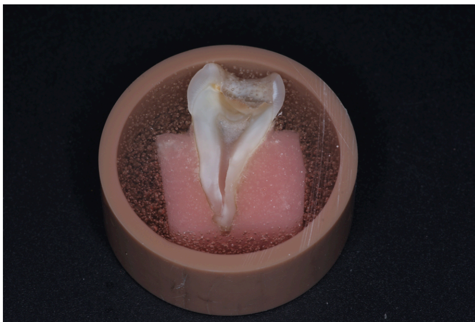
Figura 5 – Hemi-seção embutida com resina acrílica em dispositivo cilíndrico de PVC, para análise em microdurômetro
