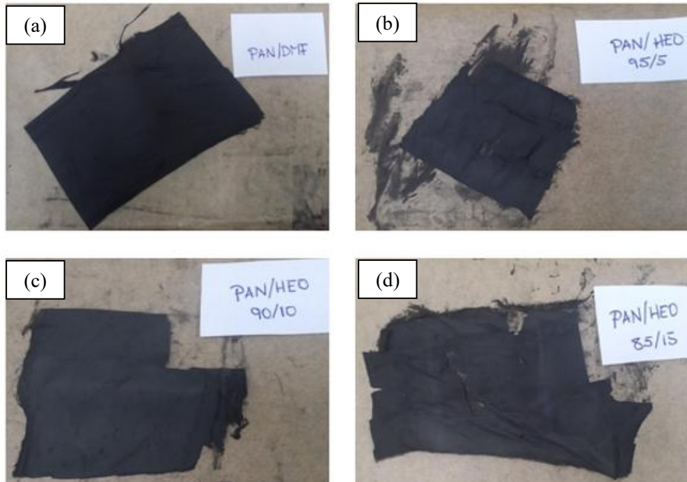
Figura 14 - Imagens das mantas fibrosas carbonizadas da PAN pura e dos compostos PAN/HEO nas concentrações de HEO: (a) 0%, (b) 5%, (c) 10% e (d) 15%.
