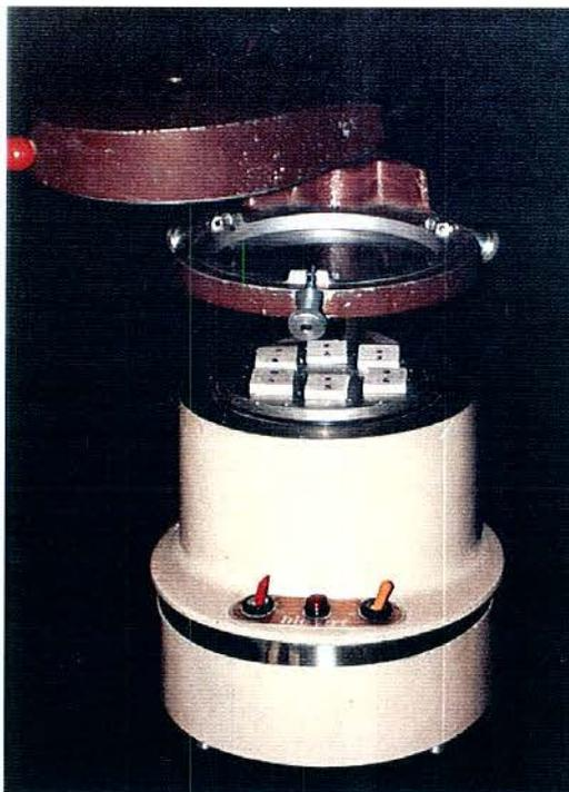
FIGURA 3- Máquina plastificadora à vácuo, com os modelos de gesso em posição.
