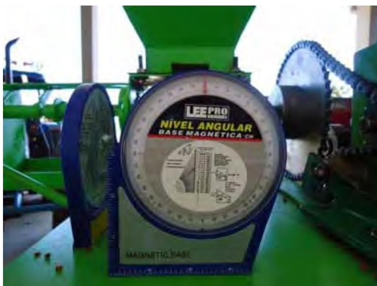
Figura 5. Inclinômetro magnético analógico.
