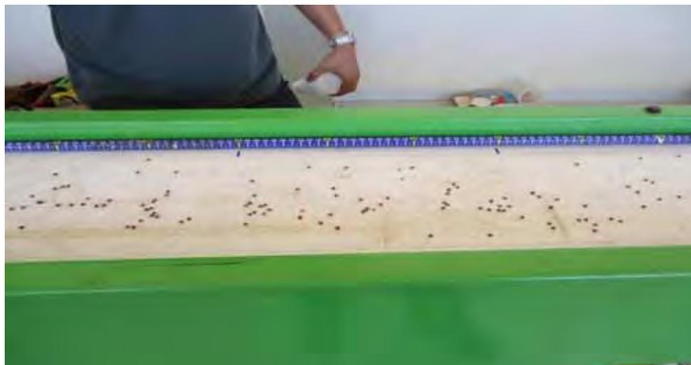
Figura 6. Sementes de sorgo depositadas em 6 m de comprimento da esteira.
