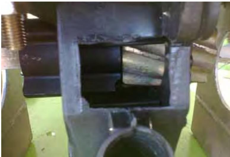
Figura 2. Mecanismo dosador de sementes do tipo rotor acanalado helicoidal utilizado no trabalho.
