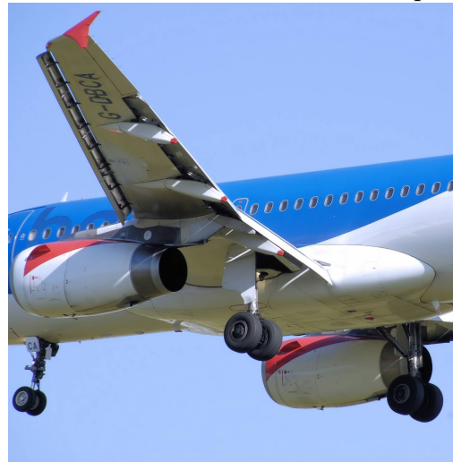
Figura 5.12: Formato da asa modificado para pouso.
