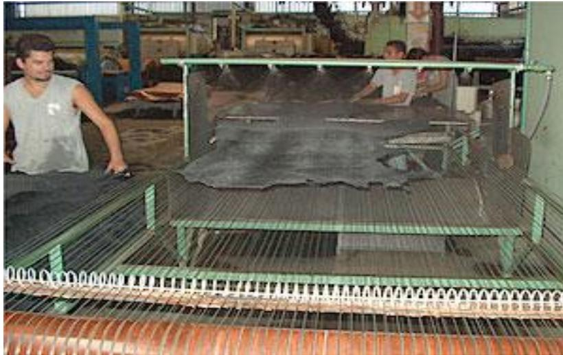
**Figura 13: Processo de Reidratação**
