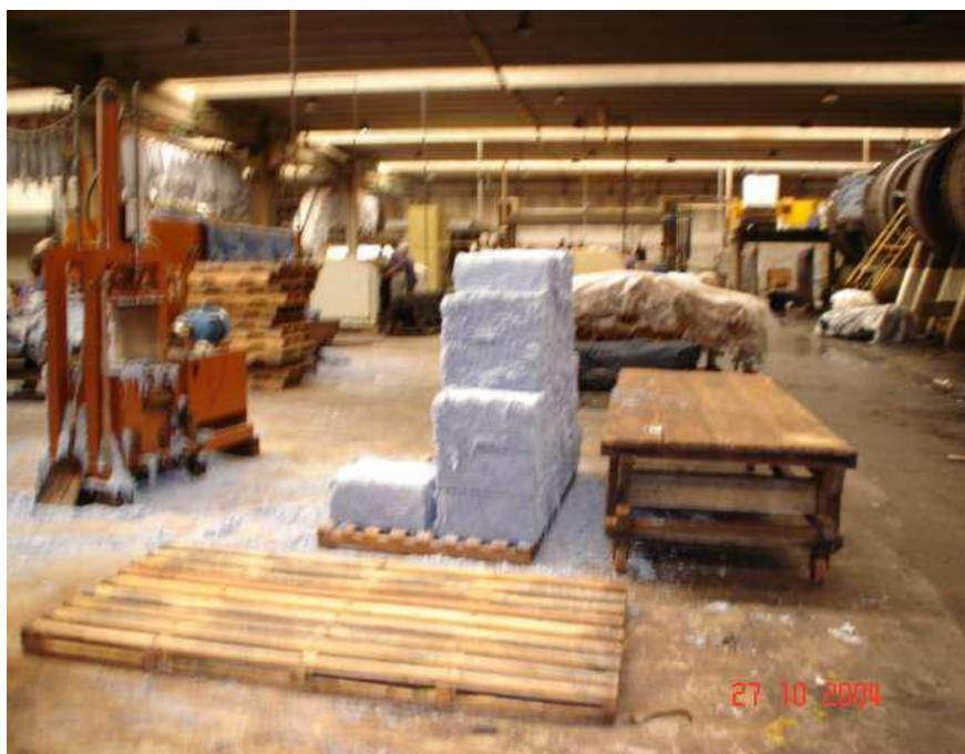
**Figura 9: Resíduo gerado na operação de rebaixamento**
