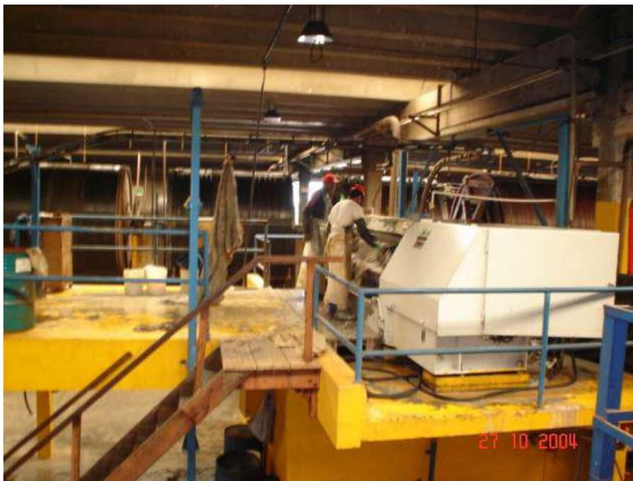
**Figura 6: Máquina de descarne**
