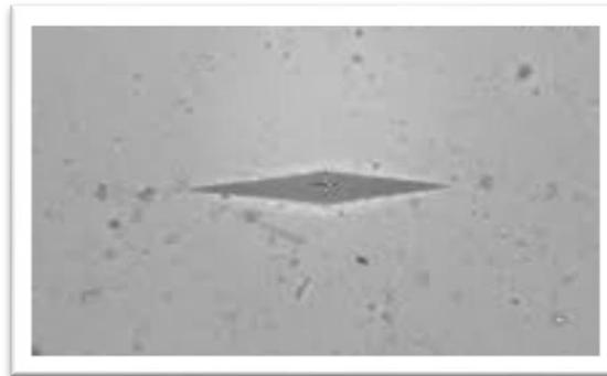
**Figura 10** - Indentação no cimento ionomérico
