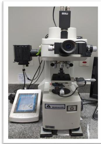
**Figura 9** - Microdurômetro Micromet 5114
