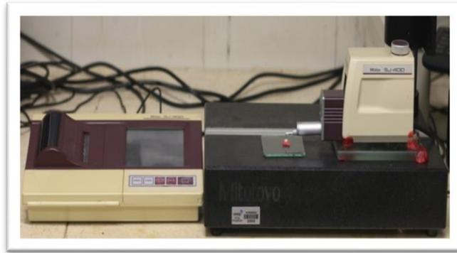
**Figura 5** - Perfilômetro, modelo SurfTest SJ 400
