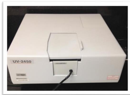
**Figura 3** - Espectrofotômetro de reflexão ultravioleta visível, modelo UV-2450
