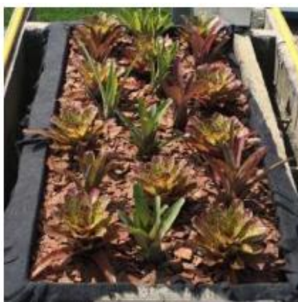
Figura 19 – Bromélias em um protótipo de telhado verde
