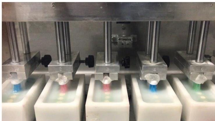
Figura 3. Cubas plásticas com as matrizes acomodadas, encaixadas na máquina de escovação.
