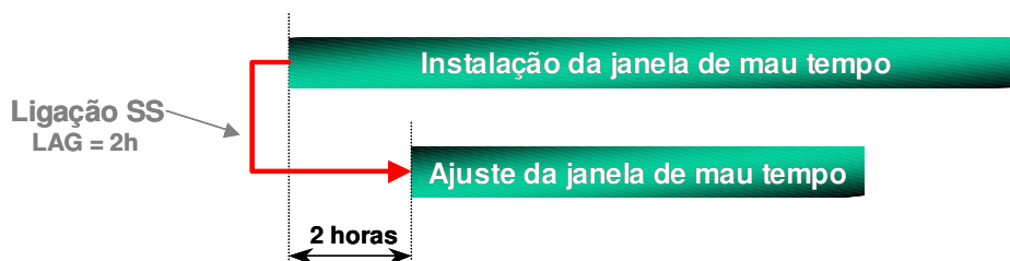
Figura 6: Ligação Start to Start (SS) com atraso de 2 horas
