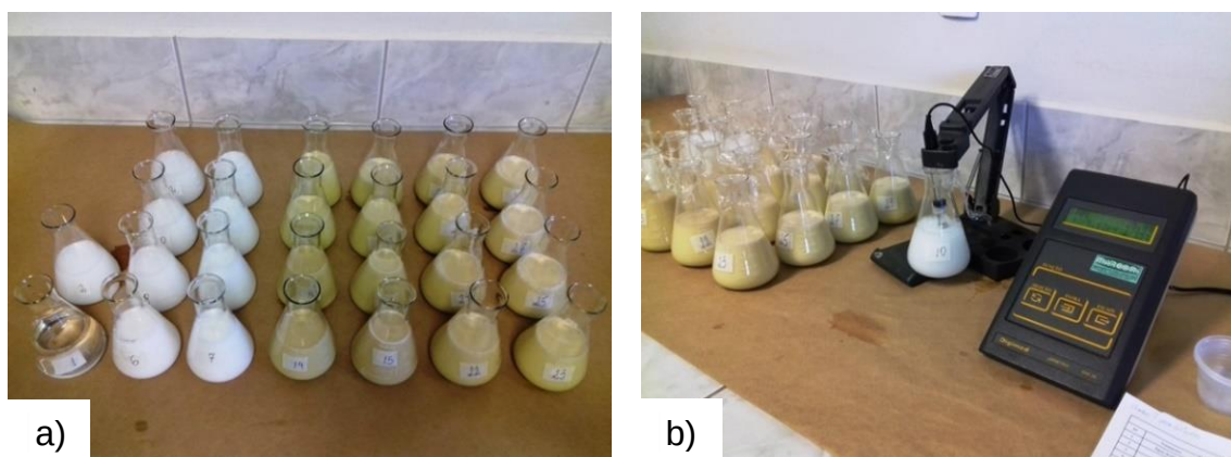
Figura 1 - Caldas fungicidas após o preparo (a); Avaliação do pH das caldas fungicidas em medidor de bancada (b)
