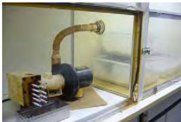
Figura1. Aparato utilizado para a exposição à fumaça do cigarro.
