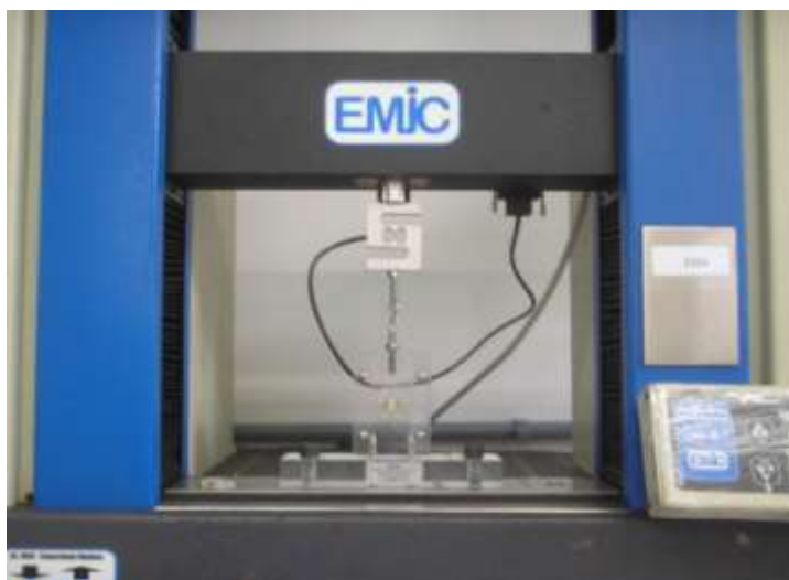
Figura 12 - Teste de microtração sendo realizado na máquina de ensaios universal EMIC.
