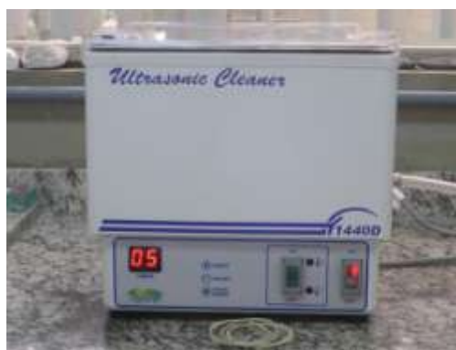
Figura 5 - Aparelho de ultra-som utilizado para limpeza dos corpos-de-prova.
