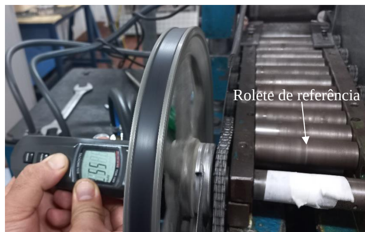
Figura 15 - Medições das rotações dos roletes para sincronização das velocidades
