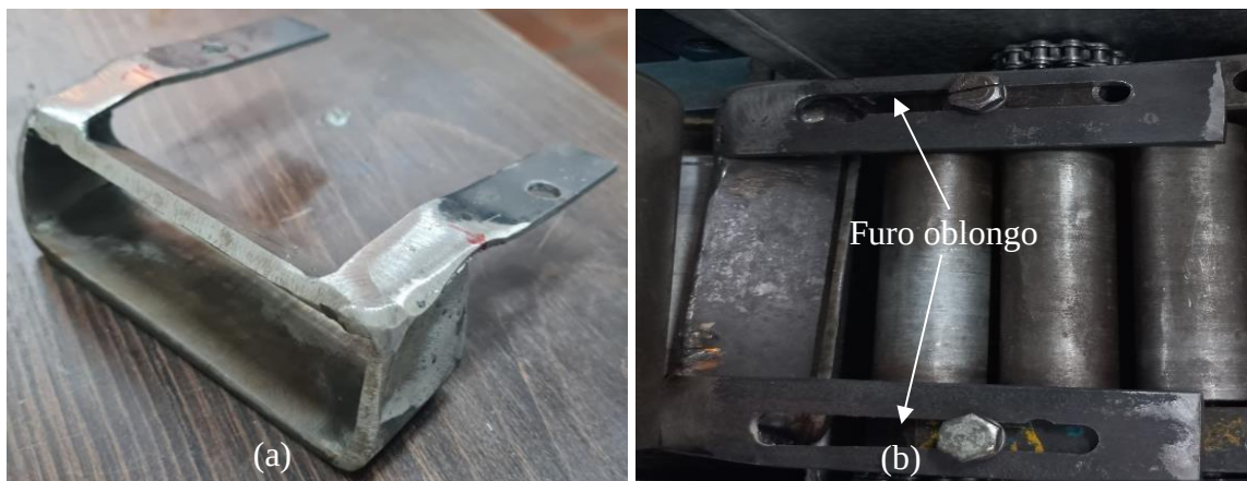
Figura 12 - Funil direcionador sem ajuste (a); funil direcionador atual com furo oblongo fixado nos roletes para aproximar dos cilindros (b)
