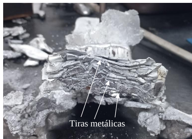
Figura 24 - Tiras empilhadas no funil de direcionamento
