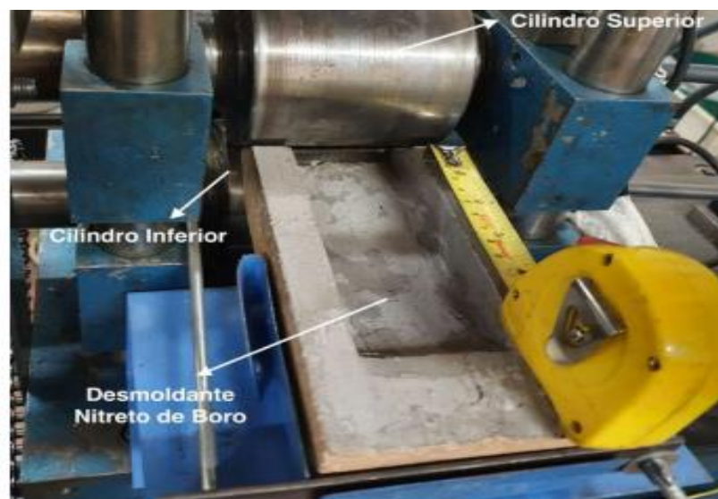
Figura 17 - Bocal que recebe o metal semissólido
