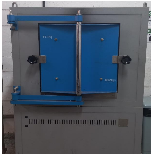
Figura 19 - Forno utilizado para aquecer a liga metálica de alumínio
