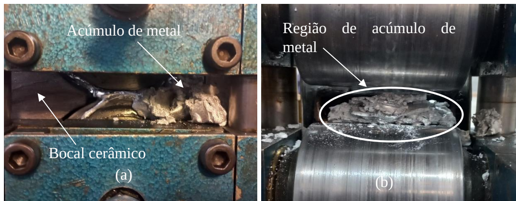
Figura 22 - Acúmulo do metal no funil direcionador: vista lateral (a) vista frontal (b)
