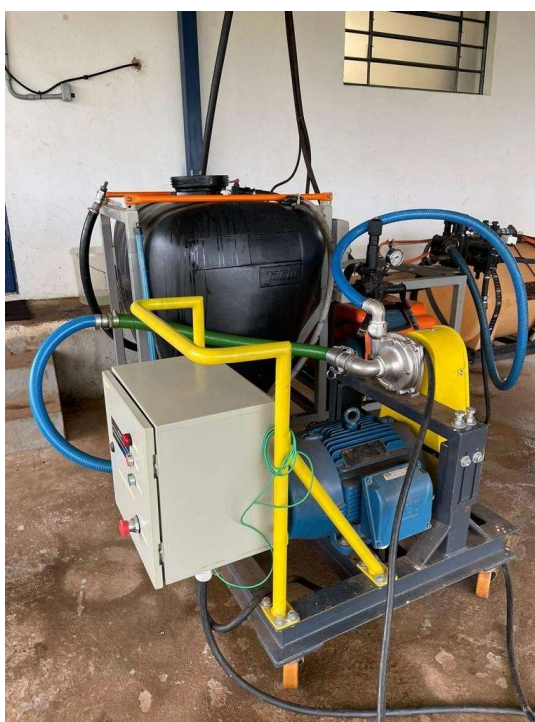
Figura 7 - Bomba centrífuga, modelo Hypro 92022S, usada no sistema
