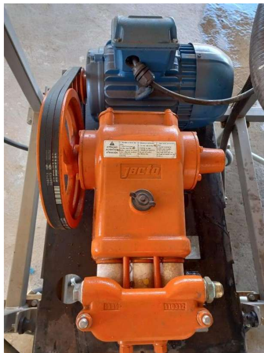
Figura 6 - Bomba de pistão, modelo Jacto JP-75, usado no sistema.
