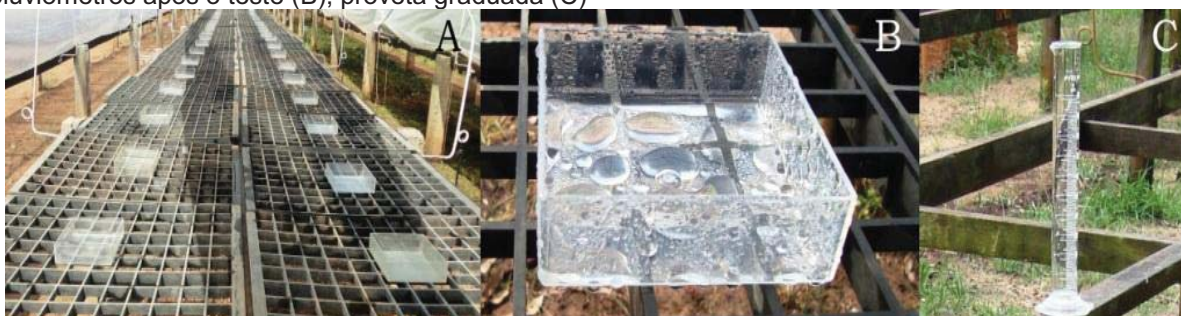
Figura 3 - Pluviômetros distribuídos de forma equidistante ao longo do canteiro (A); volume de água nos pluviômetros após o teste (B); proveta graduada (C)
