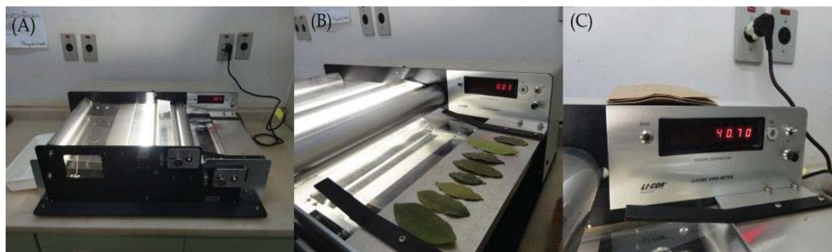
Figura 27 - Medidor de área foliar (A); folhas de uma muda antes de serem inseridas no aparelho (B); valor da área foliar total, em cm 2 , de uma muda (C)
