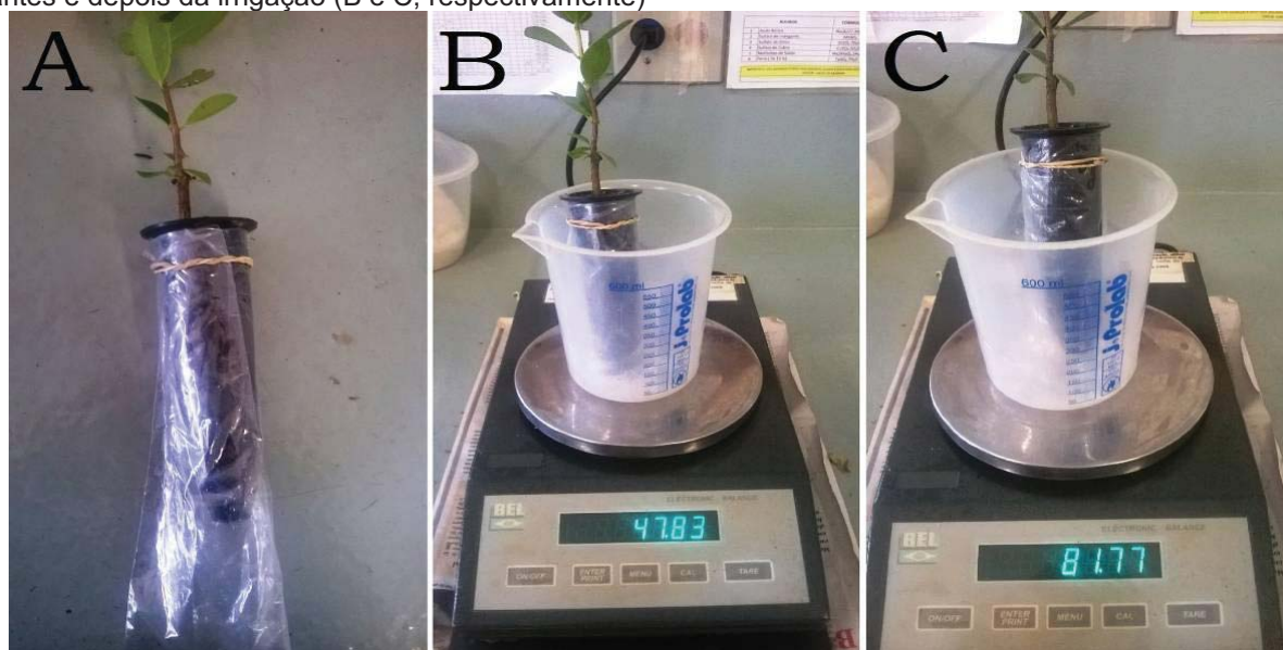
Figura 30 - Conjunto tubete+muda+saco plástico preso com elástico (A); medição da massa do conjunto antes e depois da irrigação (B e C, respectivamente)
