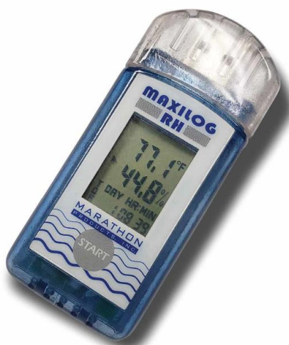
Figura 31 - Data logger de temperatura e umidade Maxilog-RH Marathon
