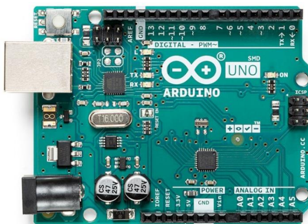
Figura 8 – Arduino Uno R3
