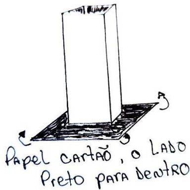
Figura 60 - Esquema de dobra da tampa com papel cartão
