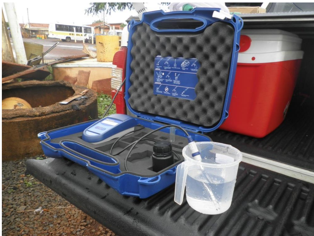
Figura 7. Medida da condutividade elétrica em campo
