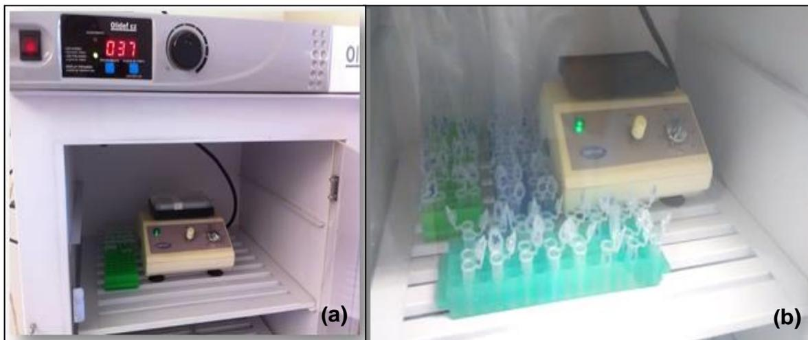
Figura 19- (a) Cultura celular juntamente com microtubos, durante a incubação de 6 horas à 37°C, sob agitação. (b) Microtubos incubados por 20 minutos, com a tampa aberta, à 37°C, durante a determinação da viabilidade bacteriana pelo método colorimétrico MTT (Brometo de (3-(4,5 dimetietiazol-2yl)-2,5-difeniltetrazolio bromido)).
