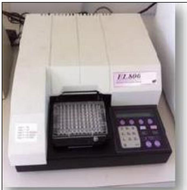
Figura 18- Ajuste do inoculo determinado pela leitura de absorbância ( $\lambda = 620 \text{ nm}$ ) em espectrofotômetro de microplaca, com densidades ópticas entre 0,100 – 0,200. Densidade óptica da suspensão bacteriana equivale a, aproximadamente,  $2,0 - 3,0 \times 10^5$  Unidades Formadora.
