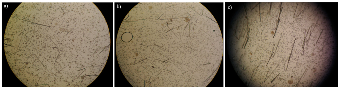
Figura 42. Avaliação microscópica da emulsão em a) 5° C, b) 25° C e c) 40° C após 30 dias de análise.
