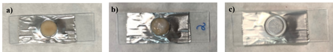
Figura 8. Preparação para o estudo de tape stripping , na qual é possível notar em a) a pele com o molde de alumínio, em b) aplicação da emulsão sobre a pele e em c) o sistema pronto para incubação.
