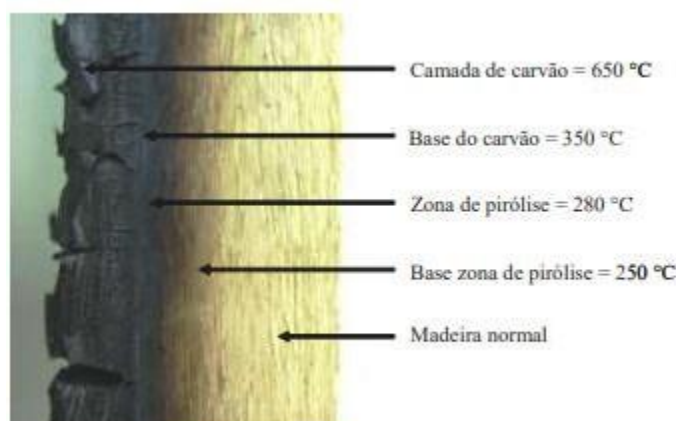
Figura 6 - Seção carbonizada de madeira
