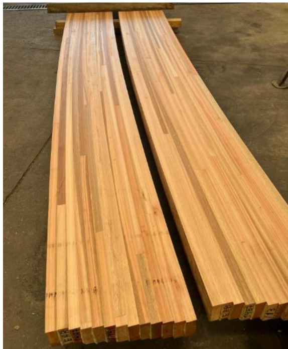
Figura 9 - Configuração de viga de MLC
