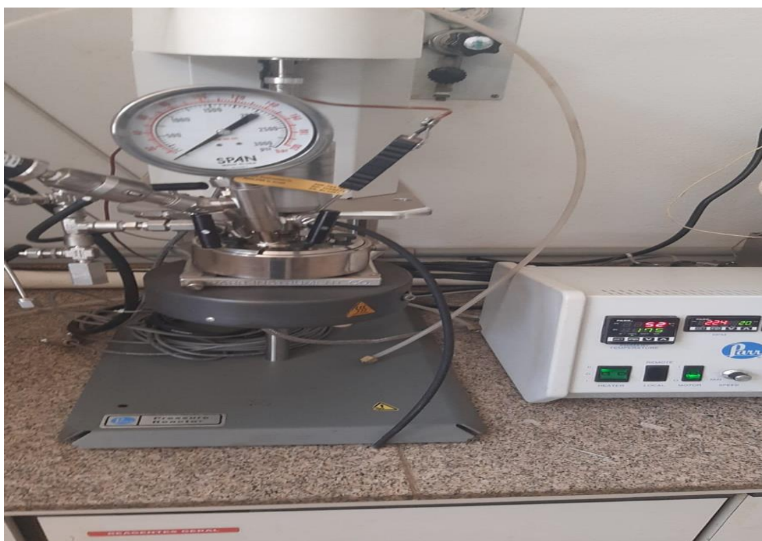
Figura 16 - Reator hidrotérmico de alta pressão e alta temperatura Termo-Parr montado
