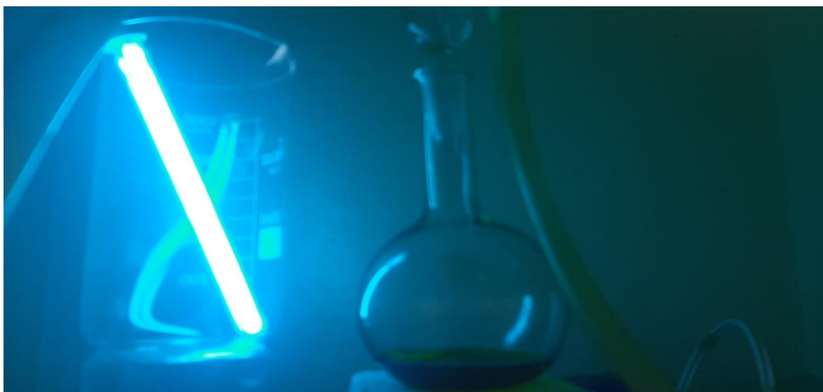
Figura 19 - Interior do reator fotocatalítico durante a esterificação
