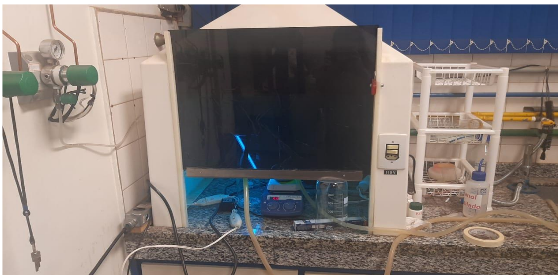
Figura 18 - Reator fotocatalítico durante a esterificação
