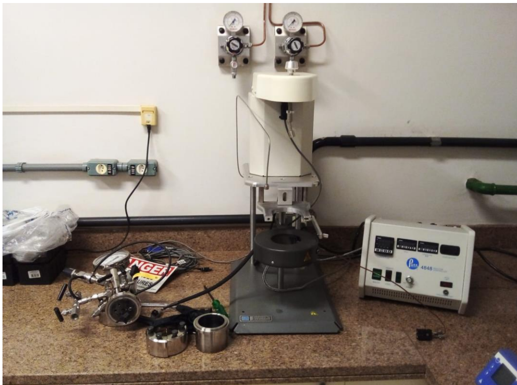
Figura 17 - Reator hidrotérmico de alta pressão e alta temperatura Thermo-Parr desmontado
