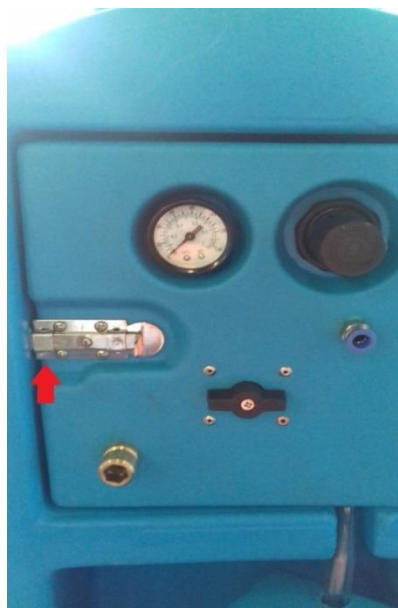
Figura 23 – Trava da portinhola da parte de trás do equipamento
