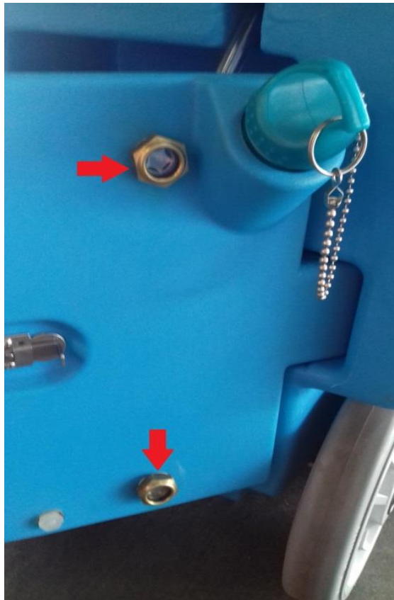
Figura 26 – Localização dos visores no equipamento
