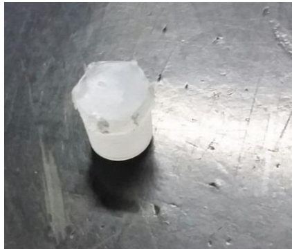
Figura 22 – Parafuso do dreno deformado
