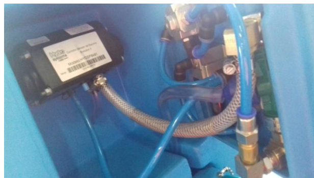
Figura 19 – Sistema fluido mecânico com a bomba pneumática
