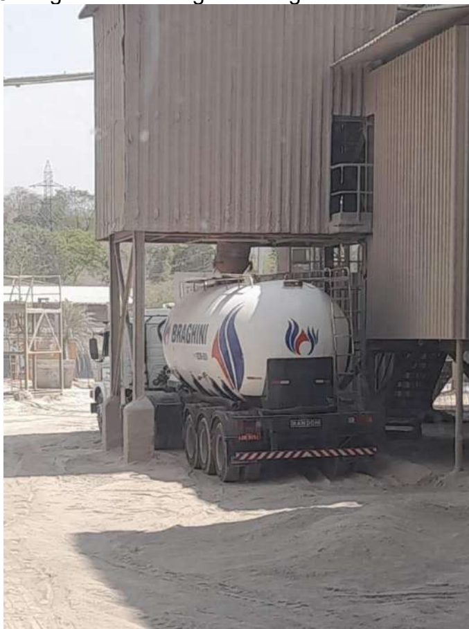
Figura 7 – Carregamento de argamassa granel com tromba telescópica
