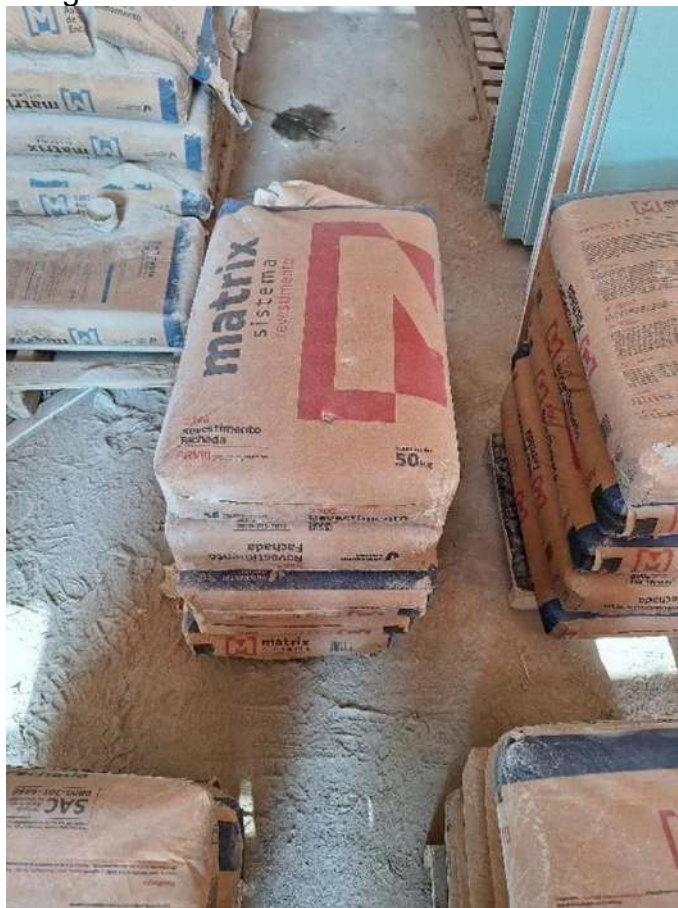
Figura 3 – Argamassa ensacada de revestimento externo fachada
