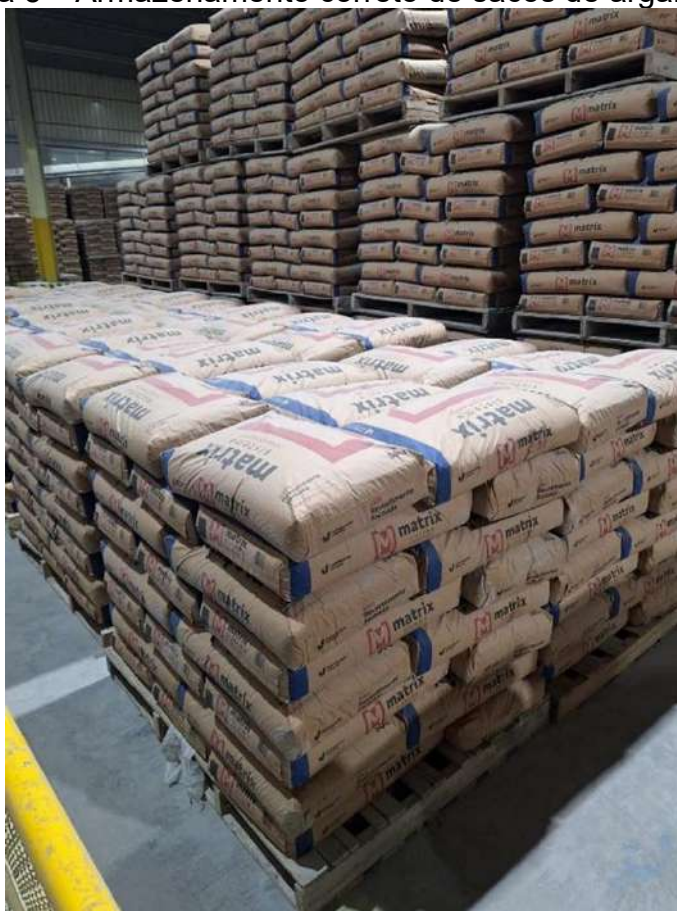
Figura 5 – Armazenamento correto de sacos de argamassa
