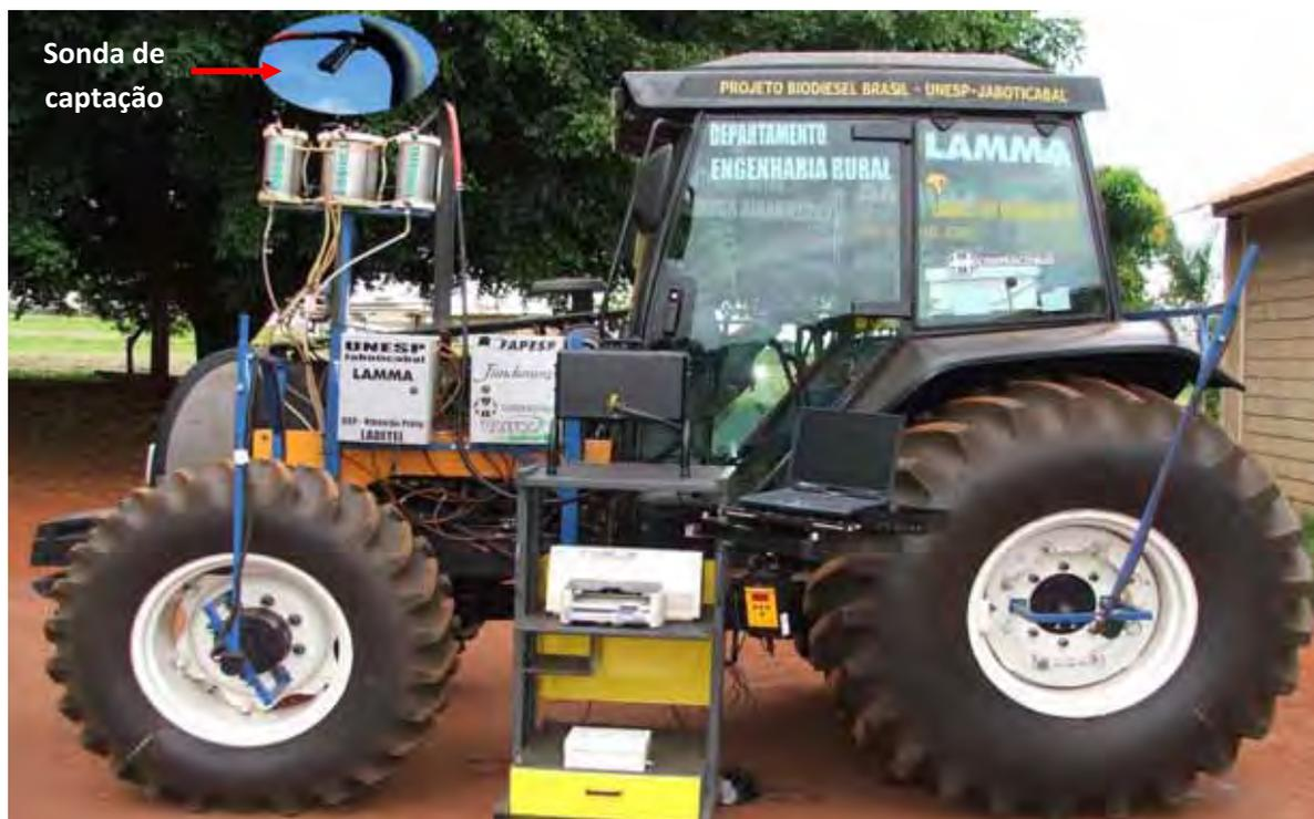
Figura 14. Vista do trator instrumentado para o ensaio de opacidade da fumaça. Fonte: LOPES (2006)
