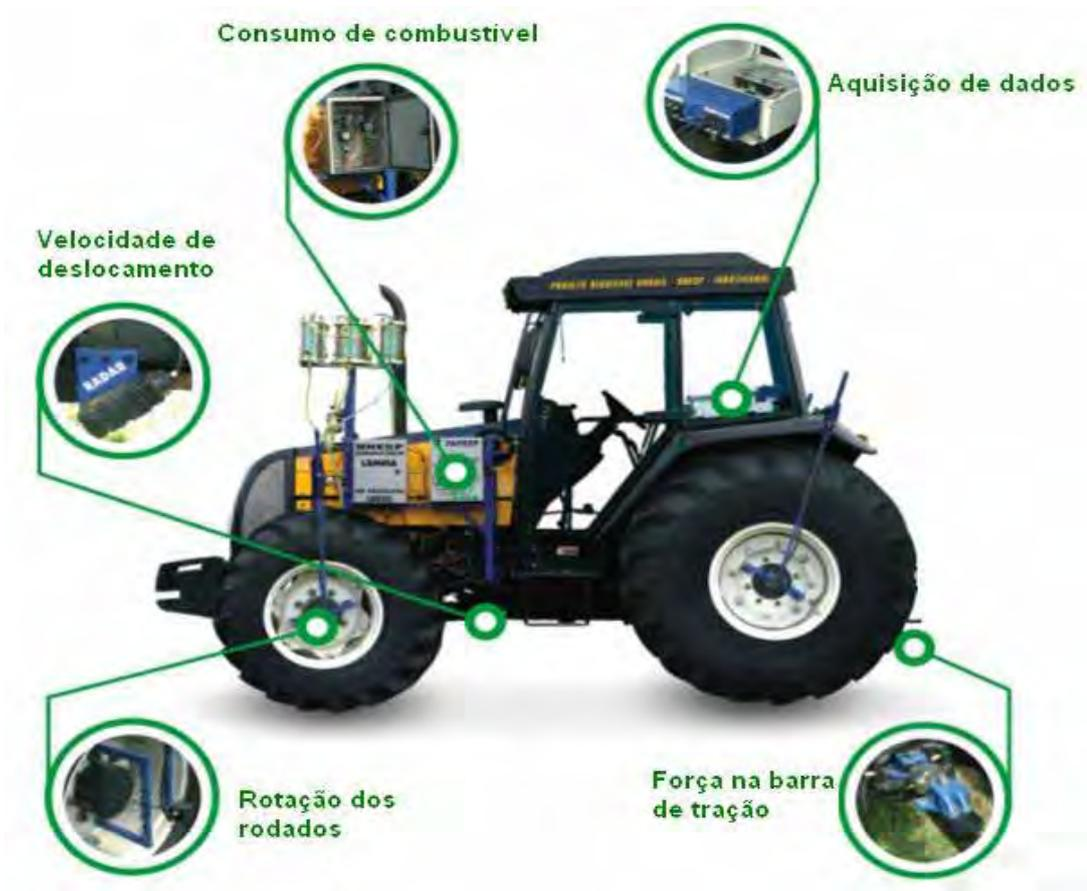
Figura 12. Vista lateral do trator de teste com instrumentação completa.
