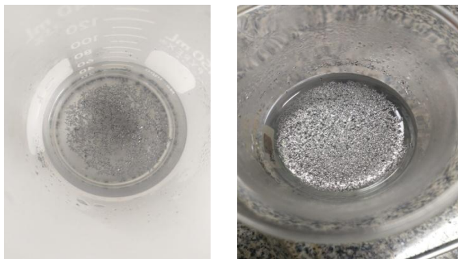
Figura 25 – Fotografia mostrando partículas aglomeradas detectadas na superfície da suspensão com água, para as amostras submetidas a ultrassom de alta potencia.
