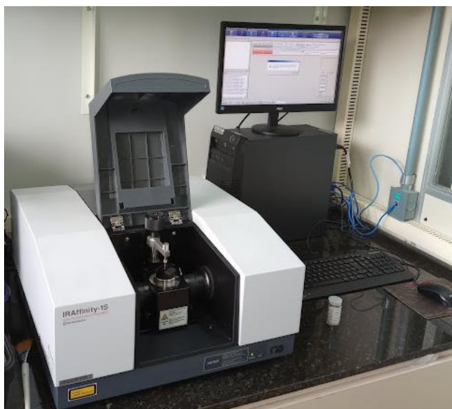
Figura 3.5 - Ensaio de FTIR-ATR das fibras de curauá tratadas e não-tratadas.
