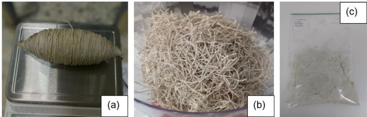
Figura 3.1 - (a) Fibra de curauá em rolo, (b) fibra cortada e (c) moída.
