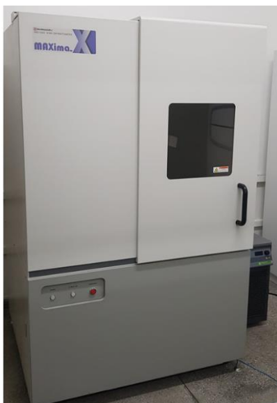
Figura 3.7 - Difratômetro de raio x (DRX), Shimadzu Maxima XRD 7000.
