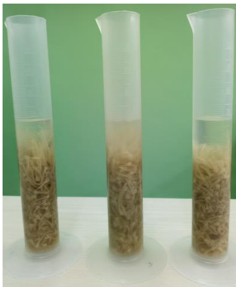
Figura 3.4 - Ensaio de determinação da massa específica da fibra de curauá.
