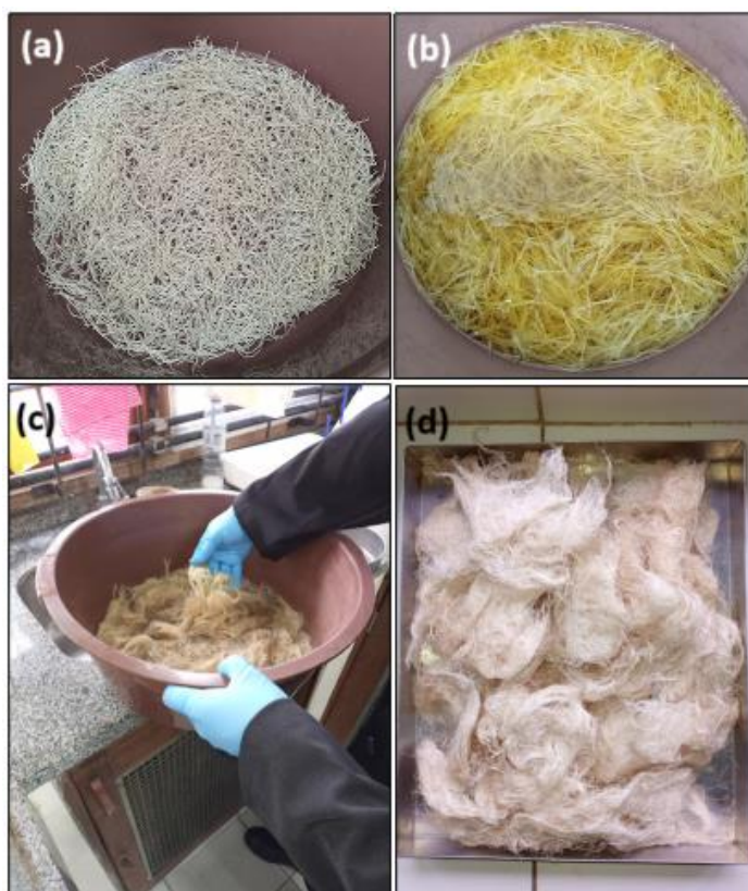
Figura 3.2 - Tratamento alcalino. (a) fibras cortadas, (b) imersão em solução aquosa de 5% de NaOH, (c) lavagem com água destilada, (d) fibras tratadas e secas.
