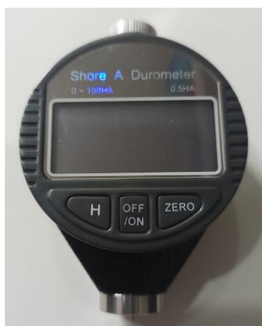
Figura 3.9 - Durômetro Kaptron, modelo FE-0063.
