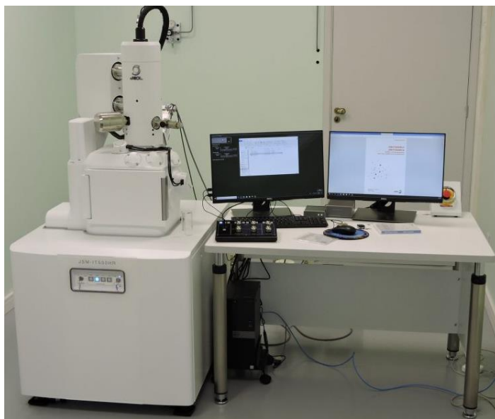
Figura 3.6 - Microscópio eletrônico de varredura (MEV), Jeol JSM IT500 HR.
