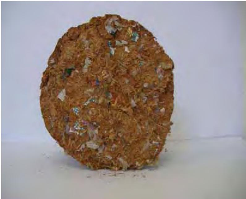
Figura 14. Vista frontal do briquete com 80% de madeira e 20% de RRSU.
