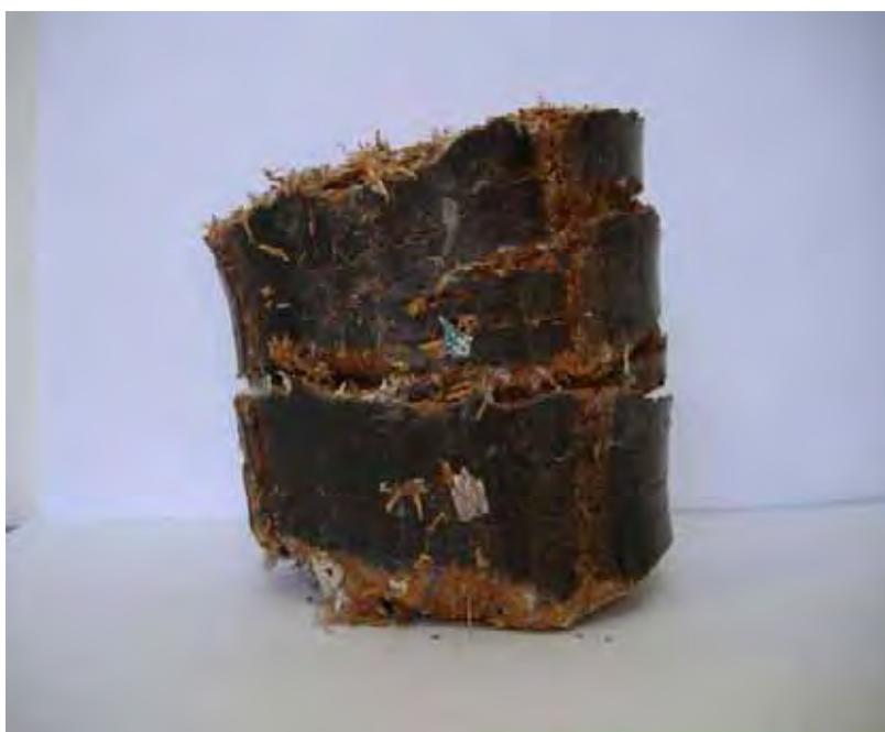
Figura 11. Vista lateral do briquete com 90% de madeira e 10% de RRSU
