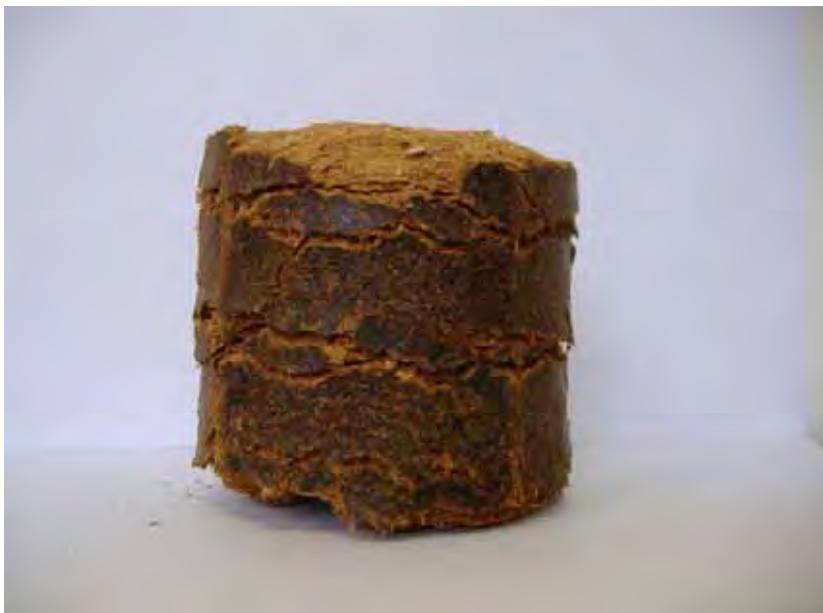
Figura 19. Vista lateral do briquete com 100% de madeira de eucalipto.lateral
