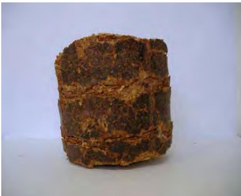
Figura 9. Vista lateral do briquete com 95% de madeira e 5% RRSU.
