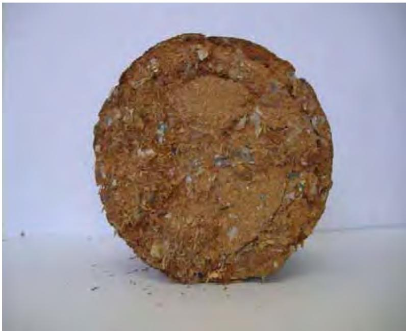
Figura 10. Vista frontal do briquete com 90% de madeira e 10% de RRSU.
