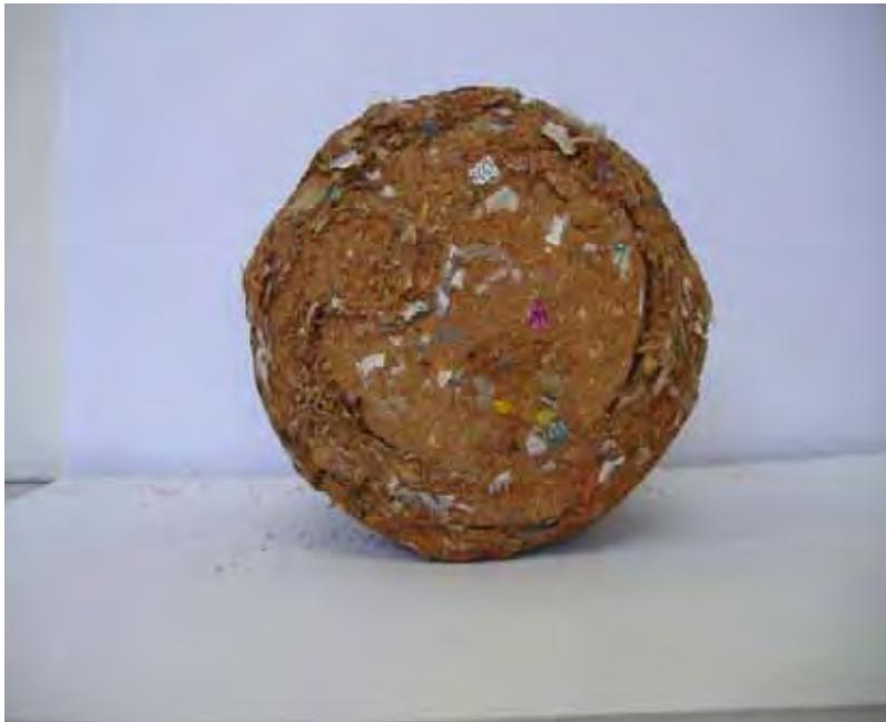
Figura 12. Vista frontal do briquete com 85% de madeira e 15% de RRSU
