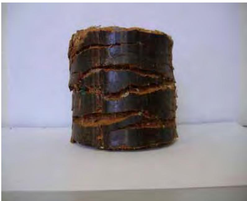
Figura 13. Vista lateral do briquete com 85% de madeira e 15% de RRSU
