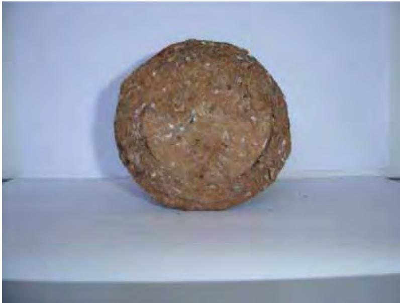
Figura 8. Vista frontal do briquete com 95% de madeira e 5% RRSU.
