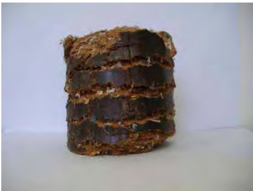
Figura 17. Vista lateral do briquete com 75% de madeira e 25% de RRSU.
