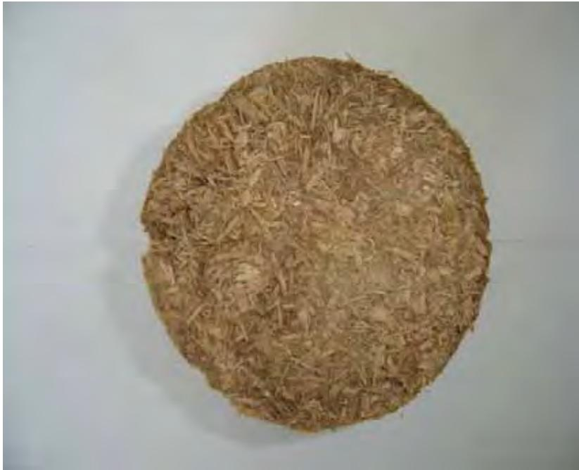
Figura 18. Vista frontal do briquete com 100% de madeira de eucalipto.
