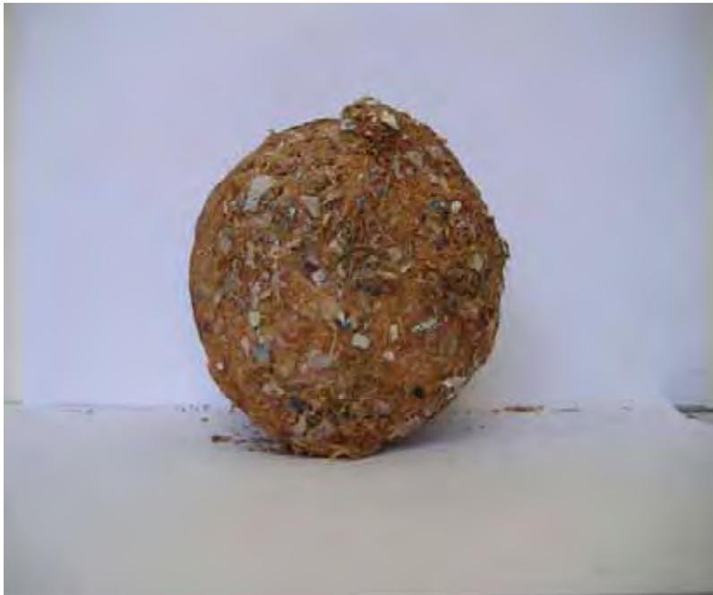
Figura 16. Vista frontal do briquete com 75% de madeira e 25% de RRSU.
