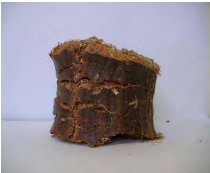
Figura 15. Vista lateral do briquete com 80% de madeira e 20% de RRSU.
