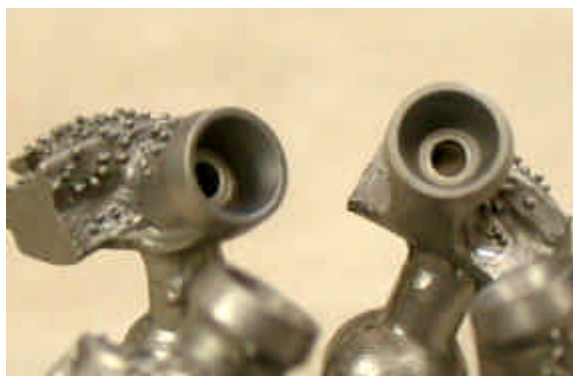
FIGURA 26 - Cilindros calcináveis fundidos em Cromo Cobalto. Observe o resultado da fundição.
