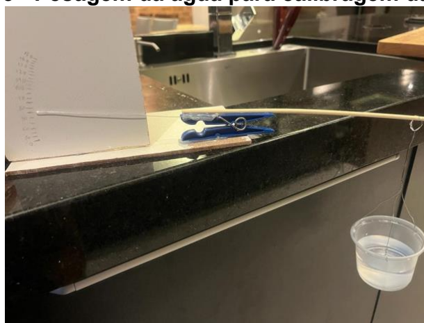
Figura 33 - Pesagem da água para calibragem da balança
