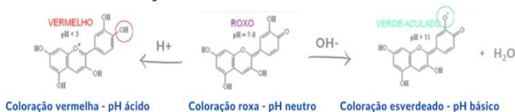
Figura 12 - Representação das mudanças na estrutura na molécula de uma antocianina mediante reação com substâncias ácidas e básicas
