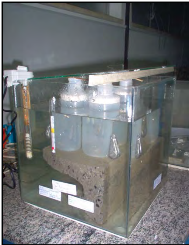
Figura 5 – Ensaio de imersão das ligas Ni-Cr-Mo em solução de NaF 0,05% (m/m)
