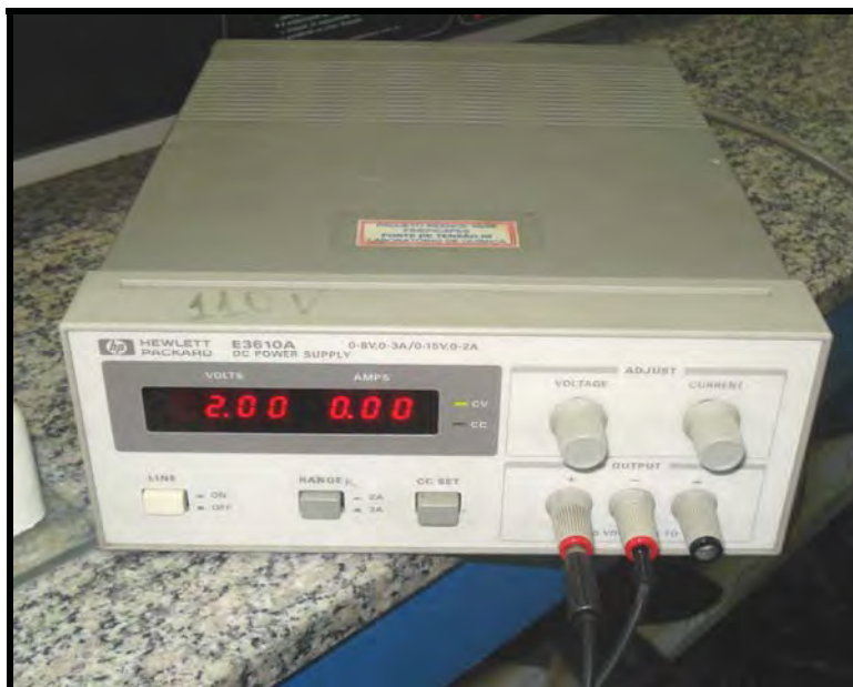
Figura 14 – Fonte de corrente contínua utilizada no ataque eletrolítico.
