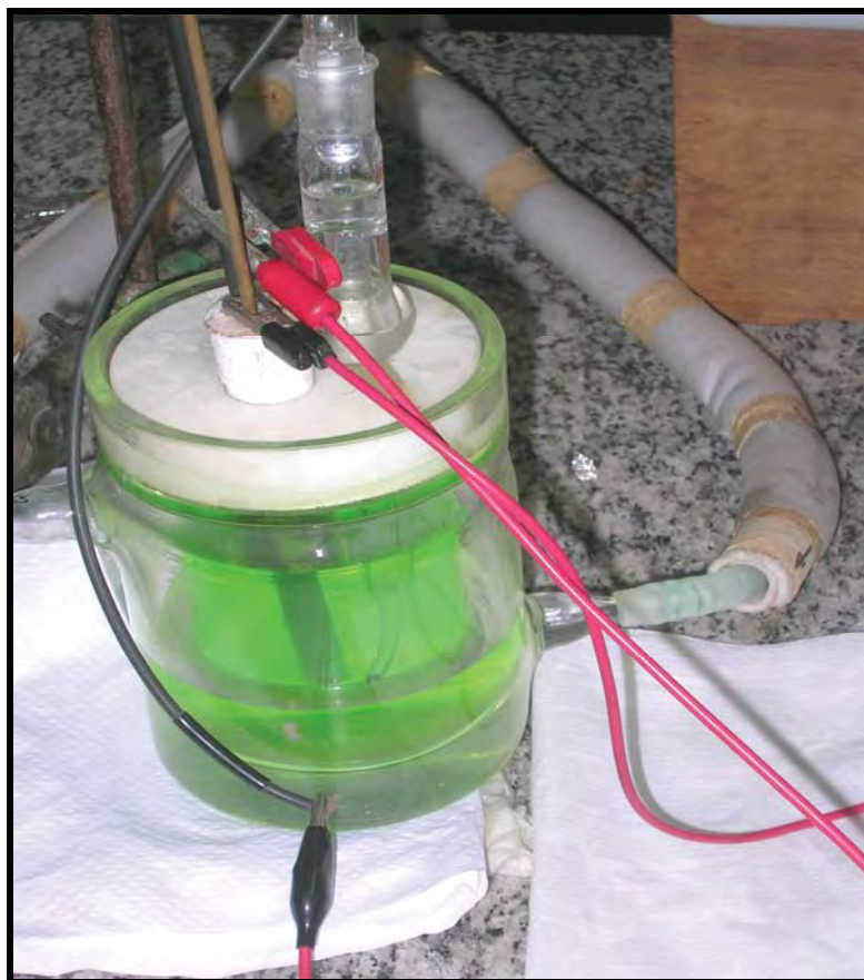
Figura 6 – Célula empregada nos ensaios eletroquímicos
