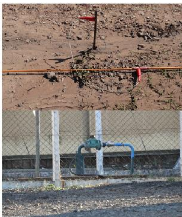
Fig. 18: Superior- conexão entre os eletrodos e os fios do equipamento Terrameter LS; Inferior- Poço artesiano objeto de estudo.
