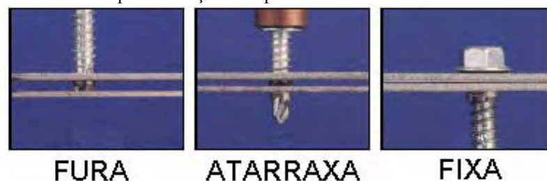
Foto 2.31 - Exemplo de fixação com parafuso auto-atarraxante e auto-brocante
