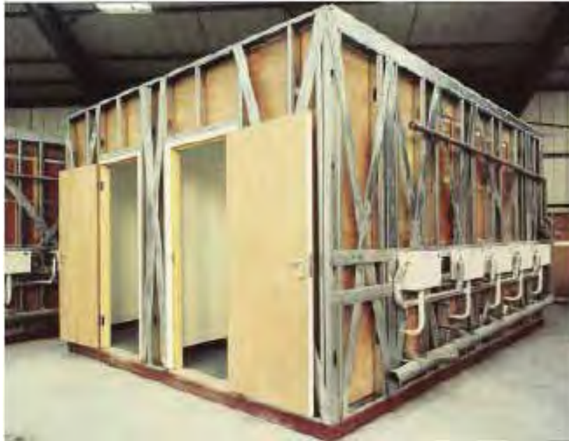
Foto 2.20 - Módulo de banheiro
