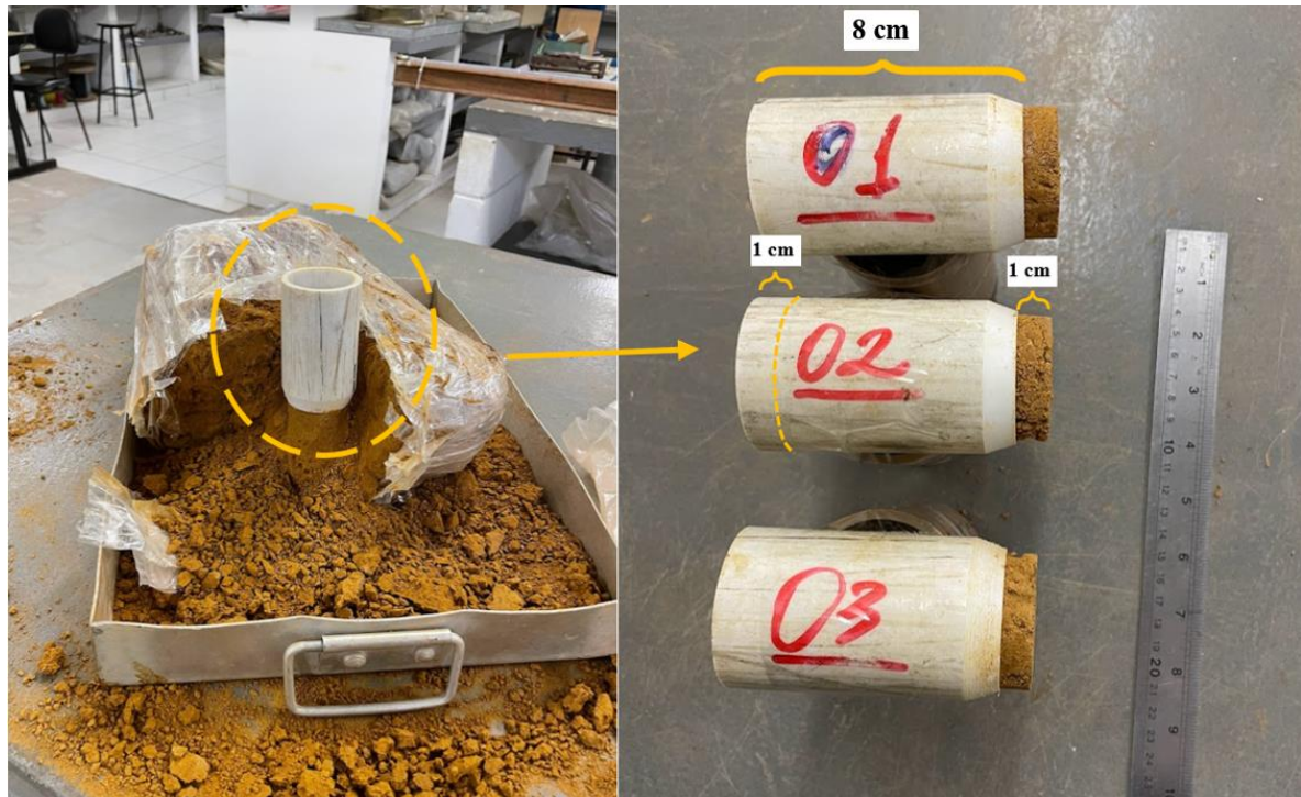
Figura 31 – Preparo das amostras do ensaio de perda de massa específica.
