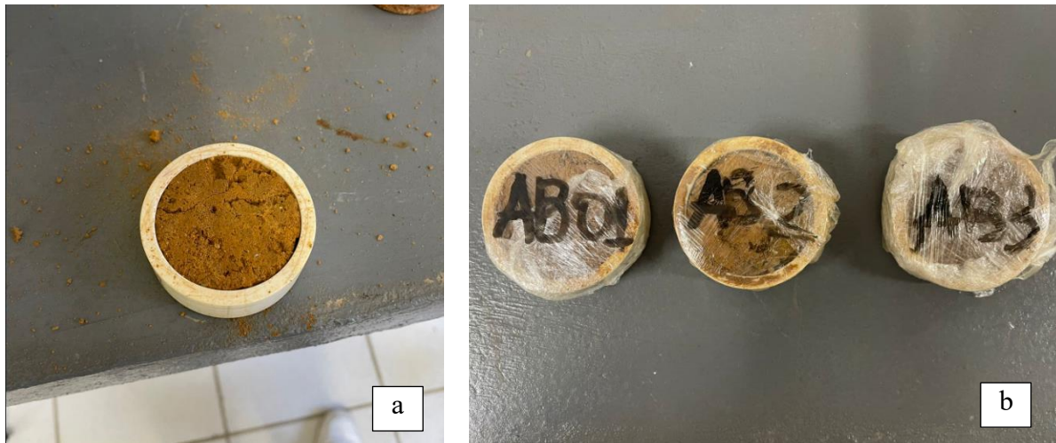
Figura 21 – (a) Amostras em anéis de PVC – talhagem, (b) armazenagem.
