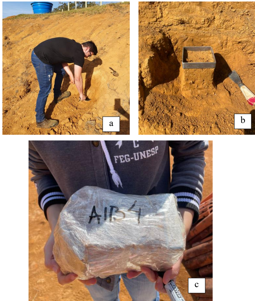
Figura 22 – Coleta de amostra do tipo indeformada do tipo bloco (a) abertura e preparação do local de coleta, (b) talhagem do bloco em campo e (c) armazenagem e identificação da amostra
