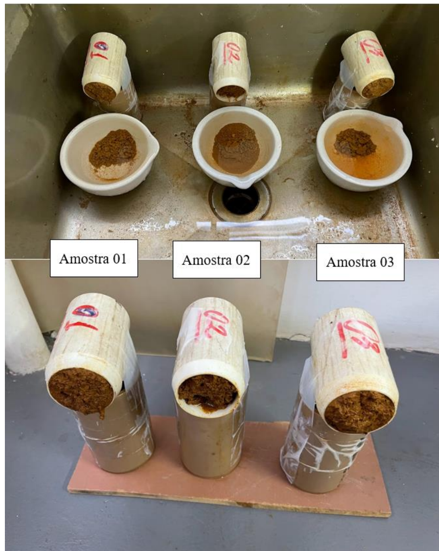
Figura 37 – Amostras dos ensaios de erodibilidade específica após a imersão de 24 horas.
