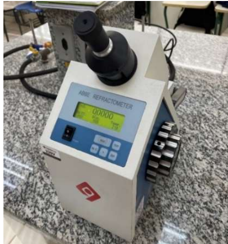
Figura 9 - Refratômetro digital utilizado para análise do Brix ( ^{\circ} )
