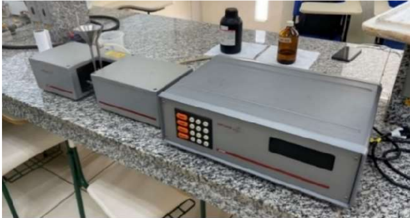
Figura 10 - Polarímetro digital utilizado para determinar a pol do caldo
