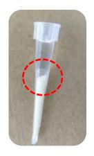
16. Aspecto após centrifugação com separação do fluido do biofilme da massa sólida do biofilme total
