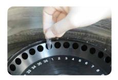
15. Centrifugação para obtenção do fluido do biofilme: 21023 g/ 4 °C/ 5 minutos
