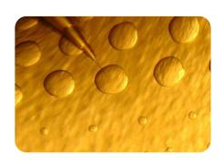
21. Vista aproximada do eletrodo de referência no interior do fluido do biofilme, tamponado com TISAB III sobre a superfície do eletrodo Orion 9409, sob óleo mineral
