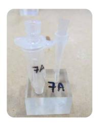
12. Conjunto para auxiliar a pesagem do biofilme
