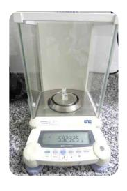
13. Pesagem do conjunto após a coleta do biofilme na balança de 5 casas (Shimadzu)
