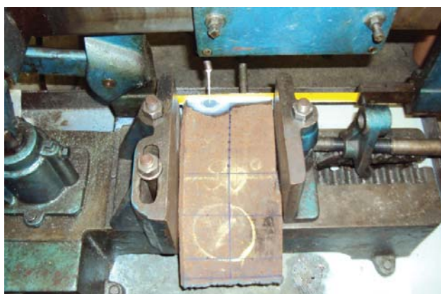
Figura 28 – Trecho de anel de tubo sendo cortado com auxílio de serra hidráulica da Oficina Mecânica do Departamento de Materiais e Tecnologia, FEG/UNESP.
