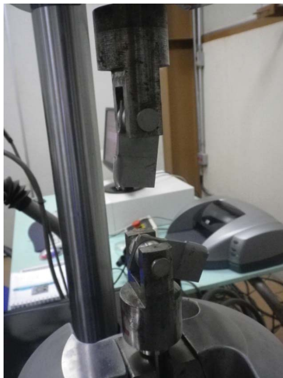
Figura 35 – Ruptura de um corpo de prova de maneira estática após a realização do ensaio.
