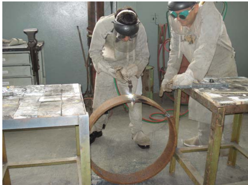
Figura 26 – Corte de um anel de tubo através do processo de oxicorte.
