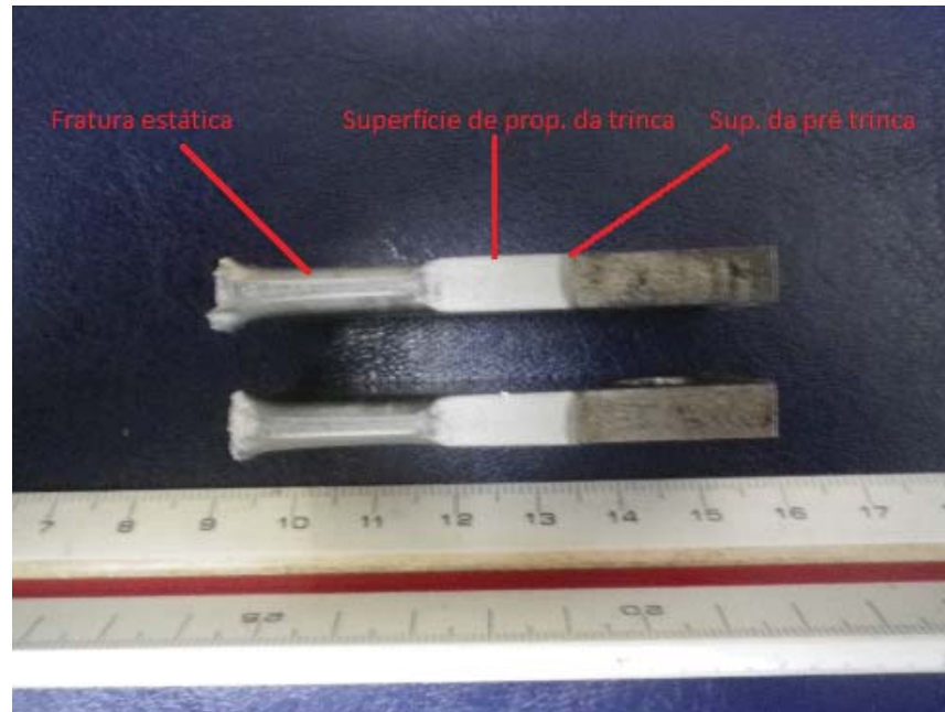
Figura 43 – Aspecto da superfície dos corpos de prova após a realização do ensaio, notar a diferença entre as regiões da pré trinca, propagação de trinca durante o ensaio e fratura estática após o final do ensaio.
