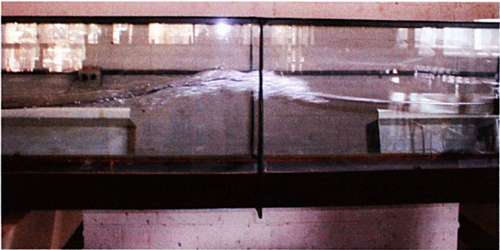
Figura 3 - Perfil de onda tipo ressalto hidráulico obtido no modelo experimental.
