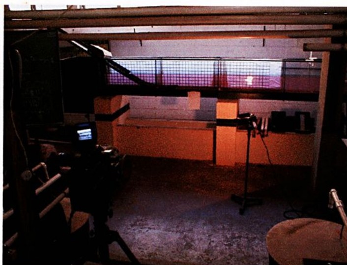
Figura 28 - Esquema de filmagem (câmera de vídeo, iluminação, malha), colaboração do Departamento de Engenharia Mecânica Feis/Unesp.
