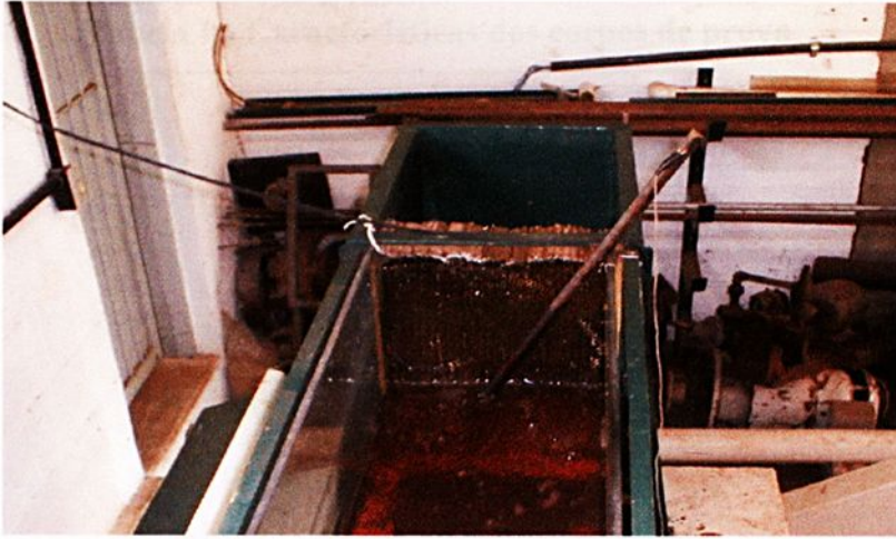
Figura 24 - Colméia para minimização do efeito de reflexão
