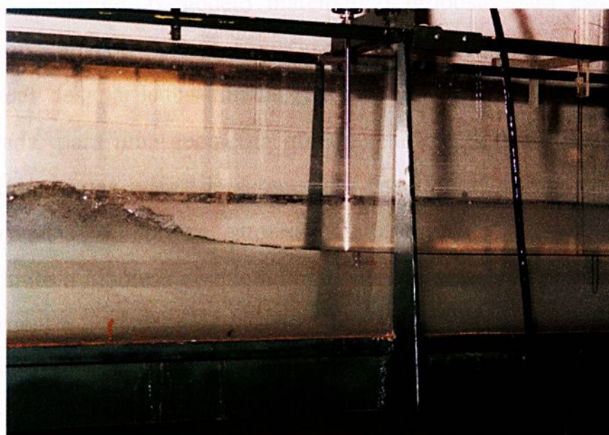
Figura 9 - Perfil de onda tipo cnoïdal obtido no modelo experimental.
