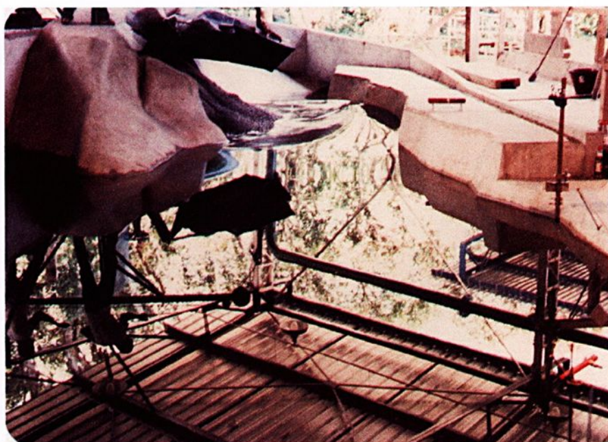
Figura 13 - Propagação das ondas para montante e jusante da região de desmoronamento e em direção ao reservatório (FONTE : Hidroesb – 1987).
