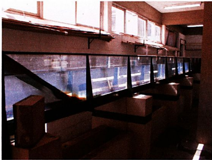
Figura 22 - Estrutura do canal (paredes de vidro, estrutura metálica e apoios de concreto).
