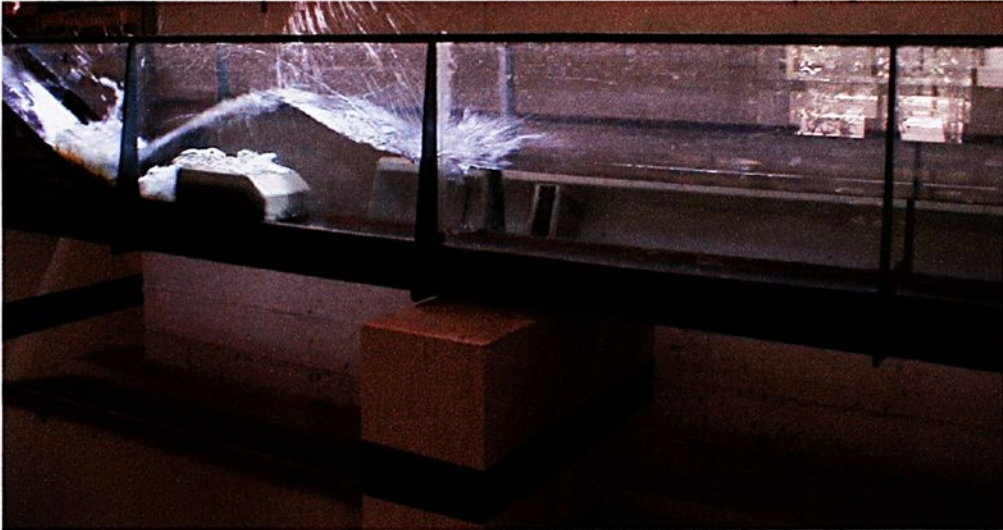
Figura 1 - Ação do bloco deslizando no interior de uma massa líquida (formação do “splash”).
