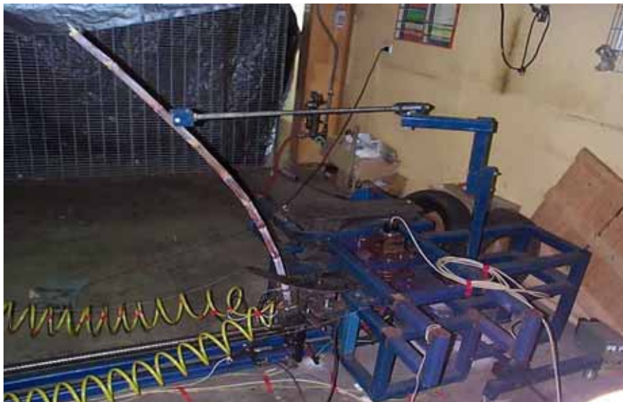
Figura 28 - Estrutura de teste com simulação de deflexão.
