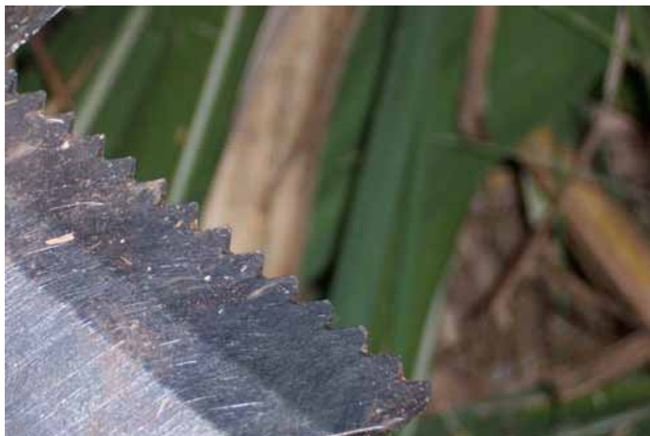
Figura 68 - Perfil serrilhado após 8 horas de uso.
