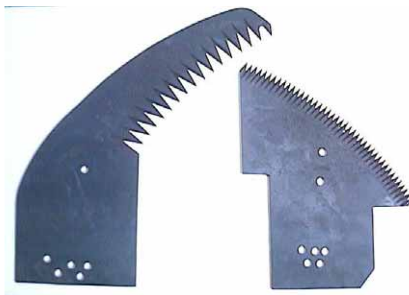
Figura 20 - Lâminas inclinadas para frente e para trás usadas no experimento de laboratório.
