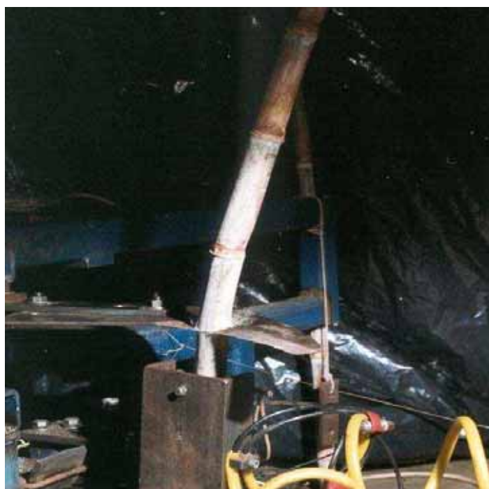
Figura 62 - Cana sendo cortada por uma lamina inclinada para frente na presença de deflexão.
