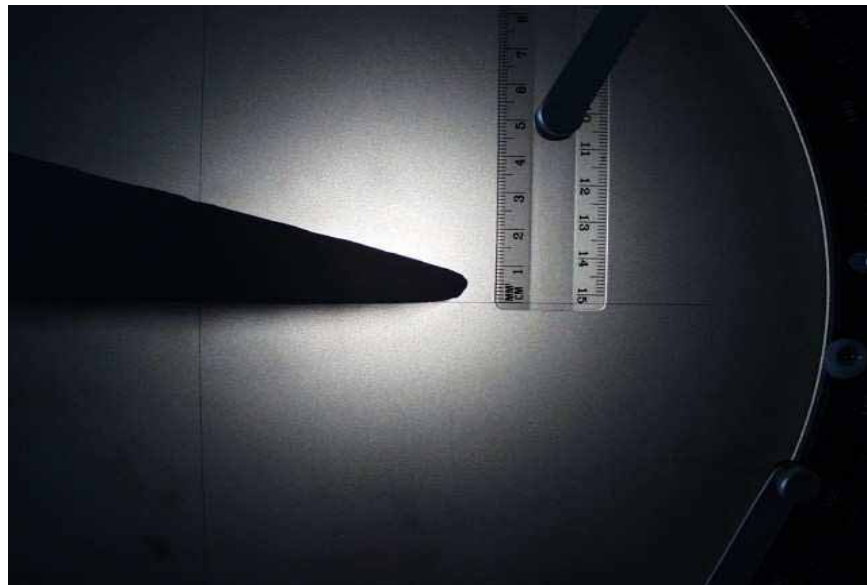
Figura 23 - Bordo cortante e ângulo de chanfro da lâmina inclinada.
