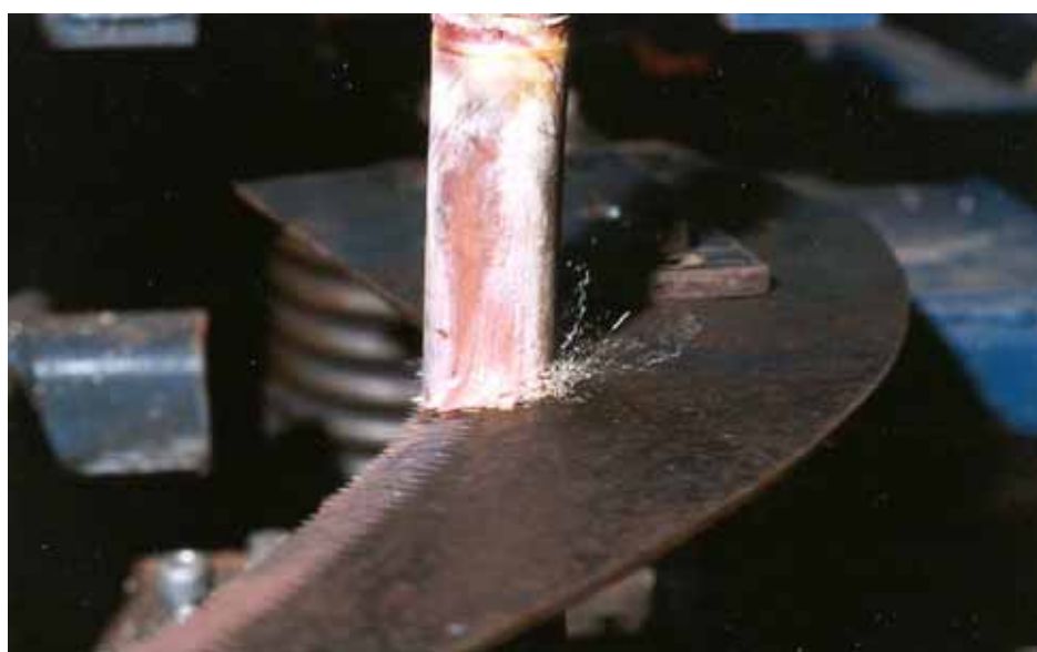
Figura 57 - Corte perfeito, sem nenhum dano, com lâmina inclinada para frente e serrilhado pequeno.
