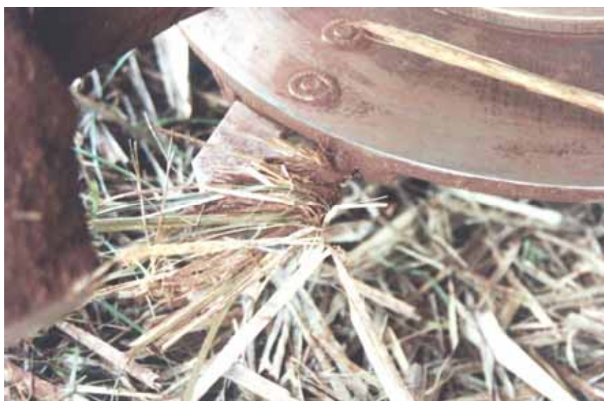
Figura 67 – Acúmulo de material entre os dentes do perfil serrilhado trabalhando em solo argiloso úmido.
