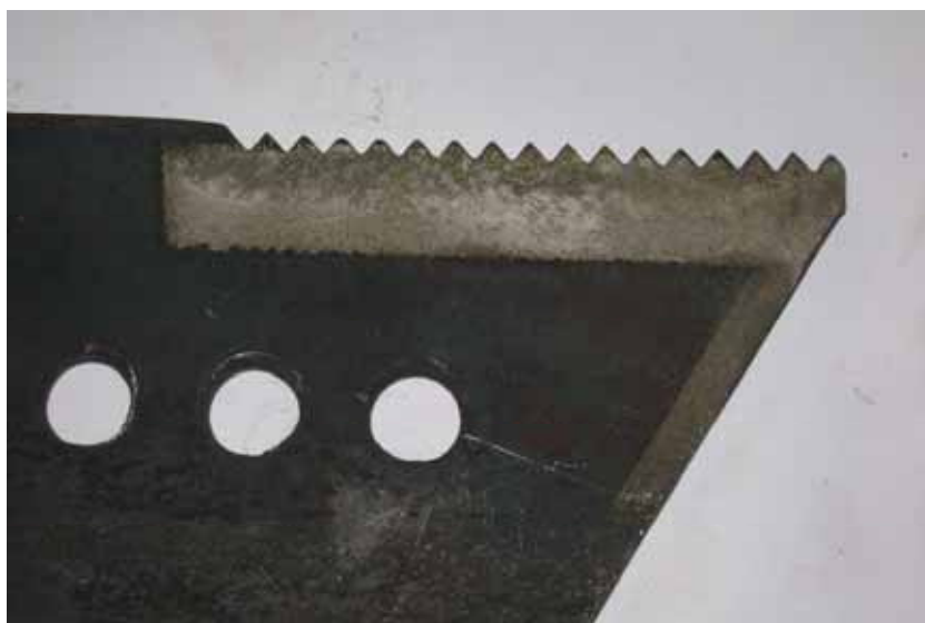
Figura 36 - Detalhe da metalização.
