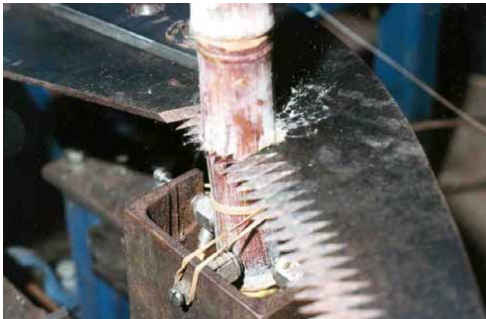
Figura 55 - Corte por deslizamento com lâmina inclinada para frente e serrilhado médio.
