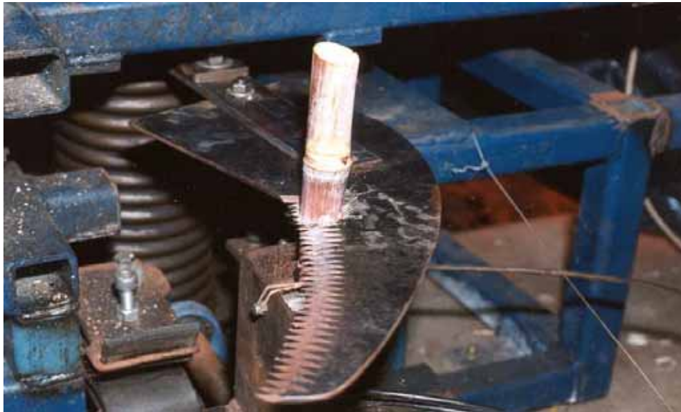
Figura 54 - Corte por deslizamento com lâmina inclinada para frente e serrilhada de passo médio.
