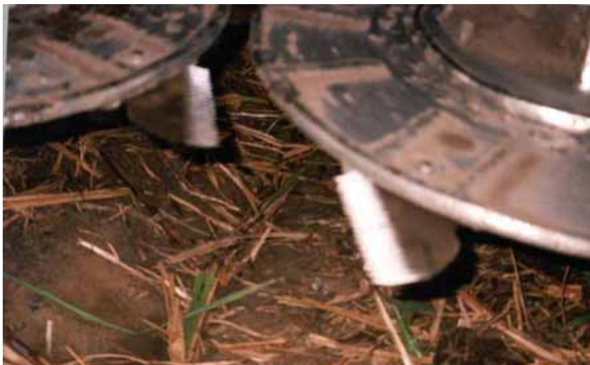
Figura 64 - Sistema de corte com lâmina serrilhada e inclinada para trás.
