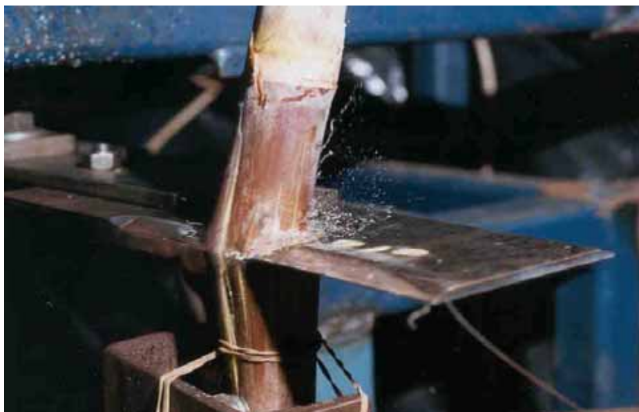
Figura 53 - Típico corte por impacto com lâmina convencional.
