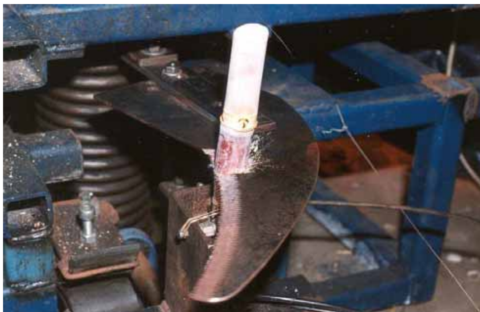
Figura 56 - Corte por deslizamento com lâmina inclinada para frente e serrilhada pequeno.
