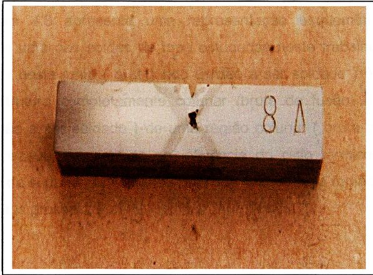
Figura 4.7: Superfície do corpo de prova polida e atacada
