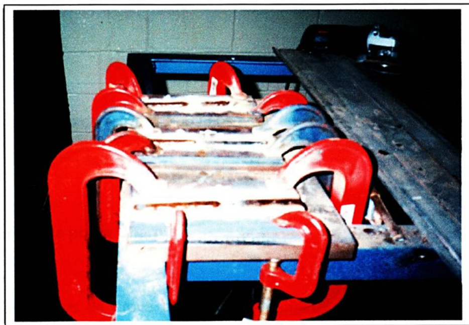
Figura 4.3: Corpos de prova soldados e mantidos fixos na mesa para evitar um possível empenamento das chapas.
