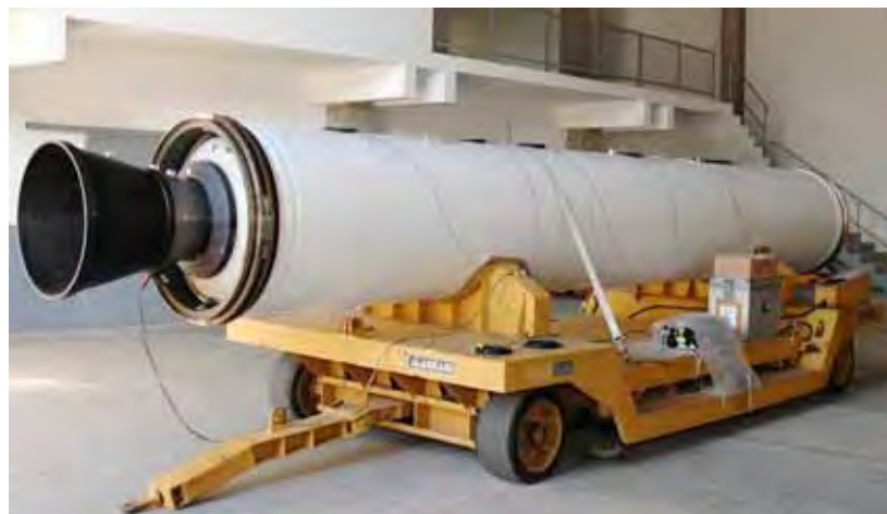
Figura 2.10 – Motor foguete a propelente sólido S-43 (IAE)
