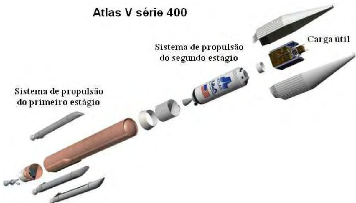
Figura 2.5 – Sistema de propulsão do Atlas V série 400 (Adaptado United Launch Alliance – ULA)
