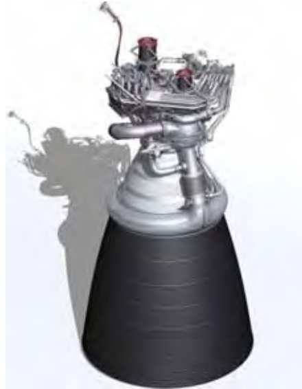
Figura 2.9 – Motor foguete a propelente líquido J-2X (NASA, 2011)
