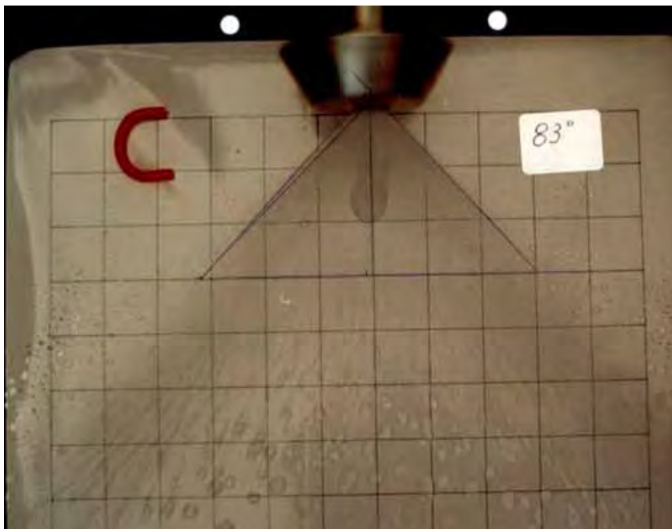
Figura 3.14 – Exemplo de fotografia de spray cônico
