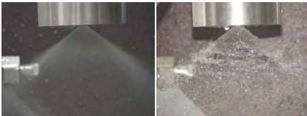
Figura 3.20 – Exemplo de fotografia dos sprays cônicos dos injetores, linha oxidante
