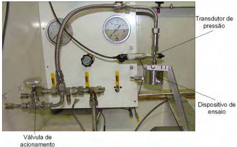
Figura 3.11 – Montagem na seção de testes do Banco de Ensaio Hidráulico
