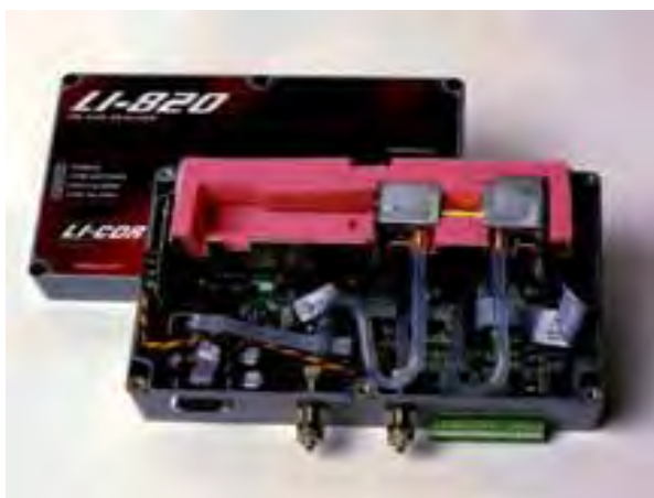
Figura 3.3 Possui banco óptico de 5 cm possibilitando a leitura do CO 2 em até 20.000 ppm
