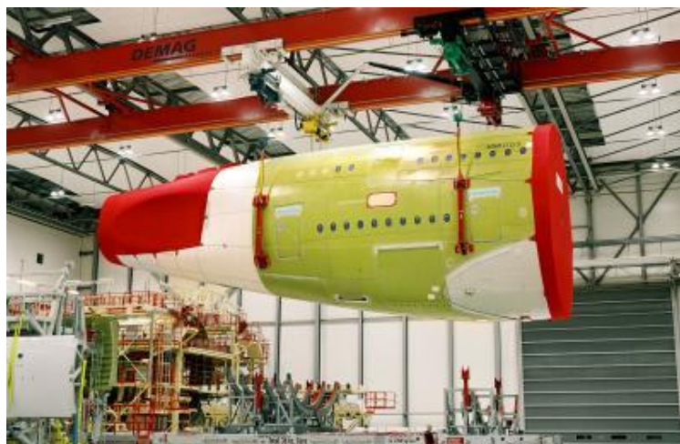
Figura 10 - Exemplo de utilização de ponte rolante na indústria aeronáutica
