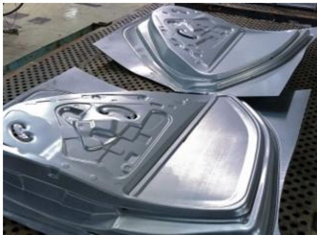
Figura 35 - Peças estampadas a partir dos blanks recortados pelo novo estampo de corte
