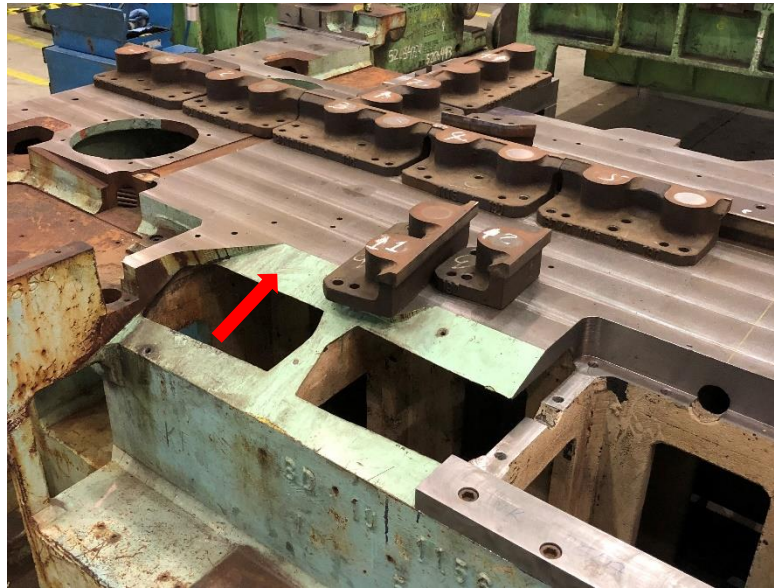
Figura 29 - Base inferior da ferramenta após usinagem
