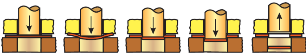
Figura 3 - Fases da operação de corte
