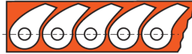
Figura 9 - Distribuição dos cortes de blank em uma tira de metal
