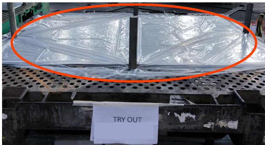
Figura 34 - Blanks recortados pelo novo estampo durante os testes
