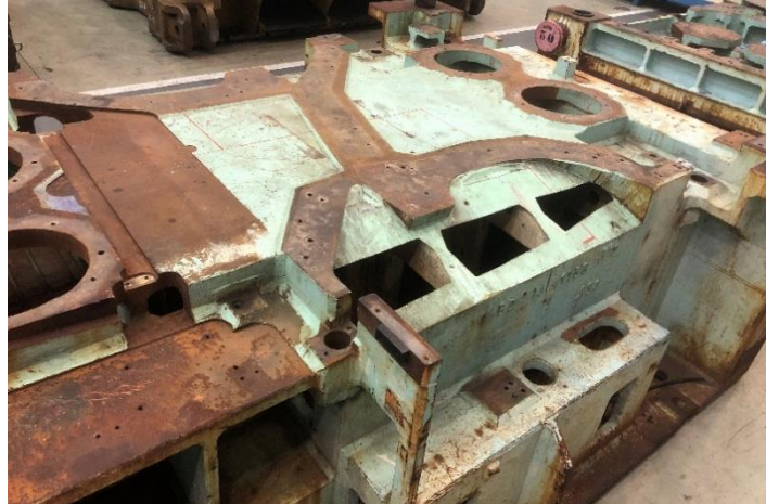
Figura 28 - Base inferior da ferramenta após limpeza
